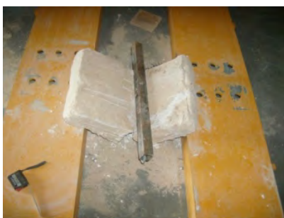
Fig. 9 – Ensaio de flexão aos blocos reparados; Fig. 10 – Avaliação da eficiência das selagens (medida em termos do valor da recuperação da resistência inicial) (créditos: autores 2009).
