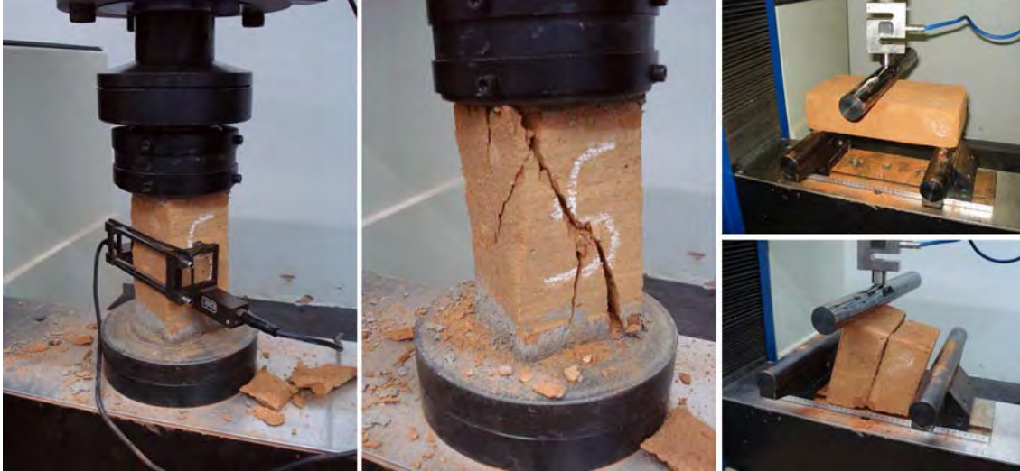
Fig. 2 - Alguns aspectos dos ensaios de determinação do módulo de elasticidade, notando-se o dispositivo de medição de deformações (extensômetros eletrônicos EMIC) e o padrão de ruptura dos CPs (à esquerda); determinação do módulo de ruptura na flexão (à direita).
