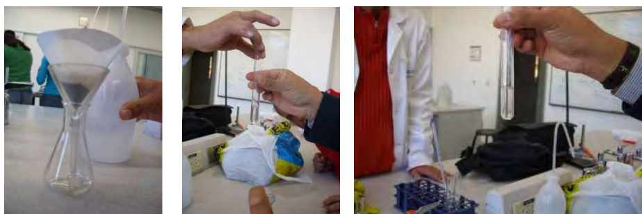
Fig. 1. Prueba de comprobación de carbonatos en la arena.
