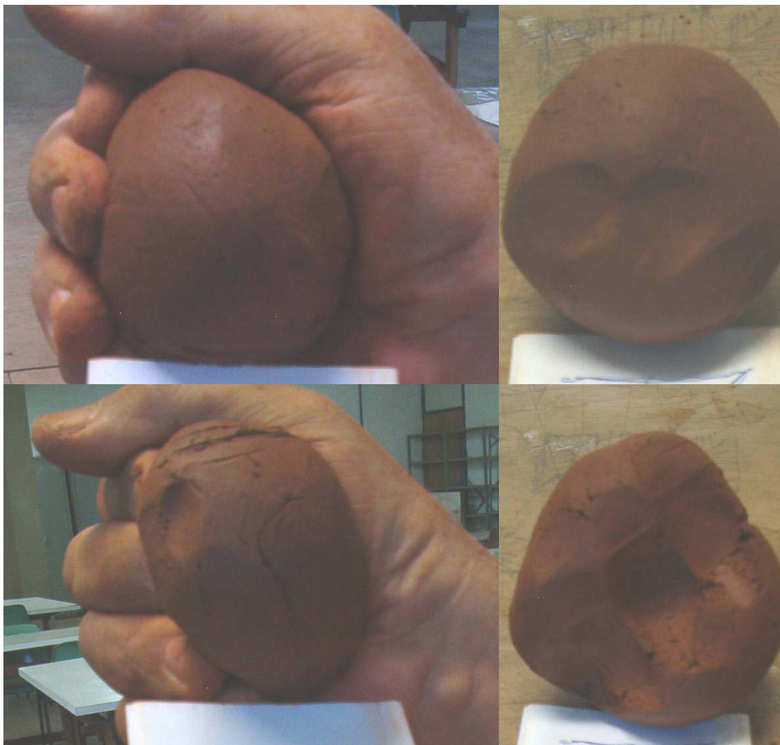
Figura 3 – Foto do teste da pressão dos dedos (Crédito: os autores, 2007)
