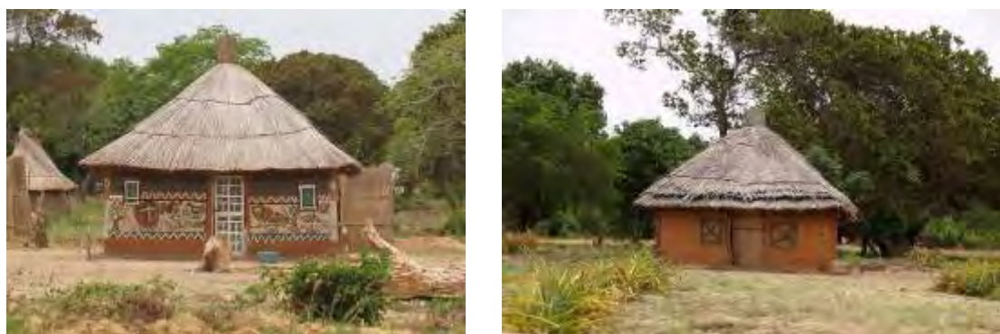
Fig. 4 Dois exemplos de palhotas com acabamentos decorativos em argamassa de barro, a segunda com apontamento a simular janelas (zona de Zonguene, perto de Xai-Xai (créditos: Margarida Donas Botto, 2009)
