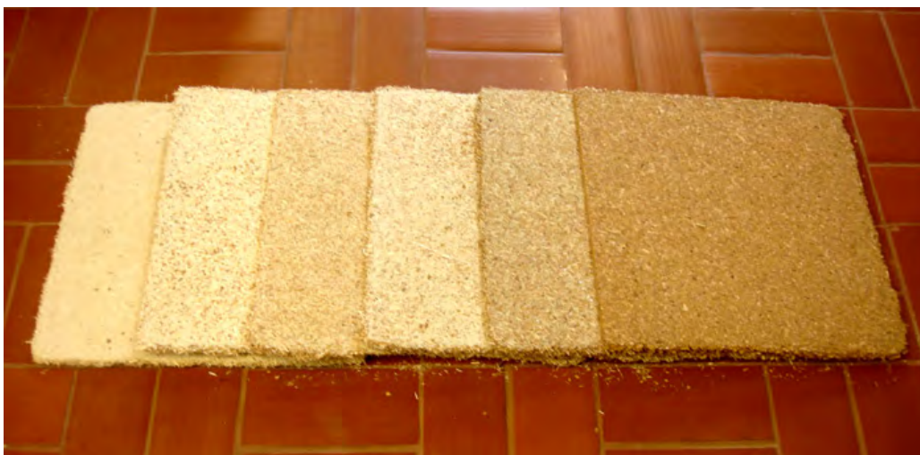
Fig. 3 - Exemplos de chapas de partículas, com rejeitos agro-industriais, usado em janelas e portas divisórias
