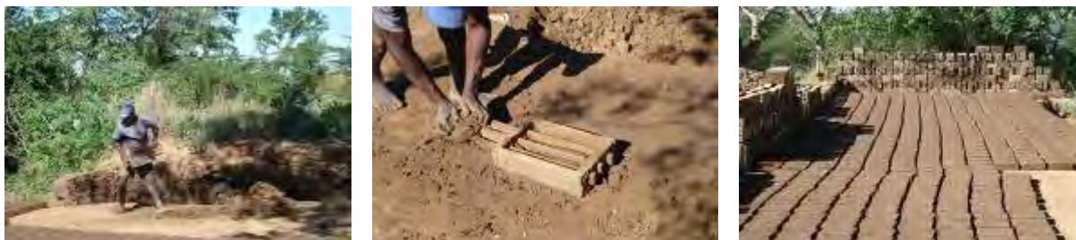
Fig 5 Extracção da terra, moldagem dos tijolos e secagem – zona de Palmeira, distrito de Gaza (créditos: Margarida Donas Botto, 2009)
