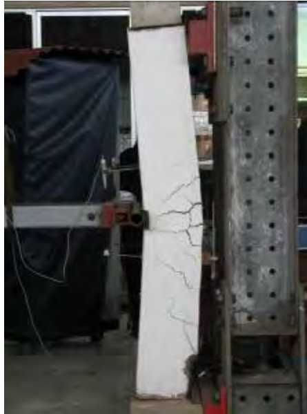
Figura 3 – Ensayo de flexión de muros de adobe
