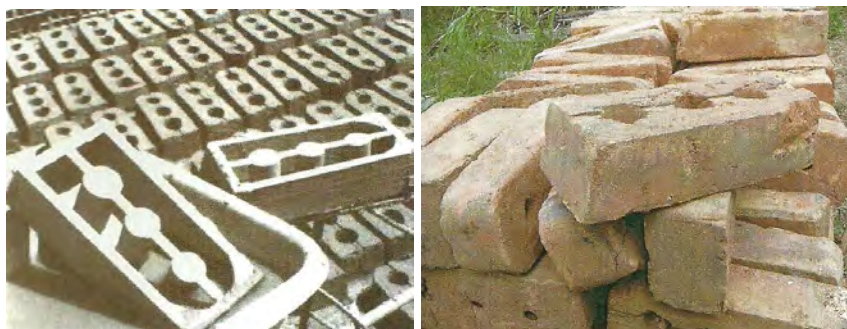
Figura 01: fôrmas metálicas e tijolos resultantes, com propriedades termo-acústicas, utilizados na cúpula do Integra. Fonte: Minke (2008) e Integra.
