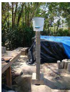
Fig 13. 72,8 kg sin fisuras de mortero. 5 arcilla, 2 de arena, \frac{1}{2} cemento. (créditos: Jim Hallock, 2010)
