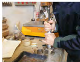
Elaboración probetas mini-harvard
