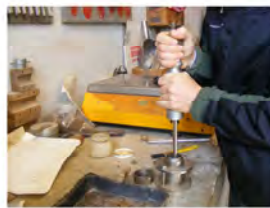
Elaboración probetas mini-harvard
