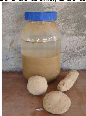
Muestra 2 El número dos tiene más arcilla que la muestra 1, es excelente, sin embargo, se requieren más de arena en la mezcla.
