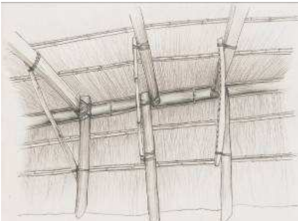
Fig. 3 y 4 Croquis interiores mostrando la disposición de las tijeras y el torillos, vinculadas a las costaneras y la cumbrera.
