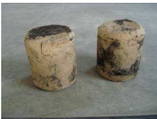
Foto probetas ensayadas a absorción de agua
