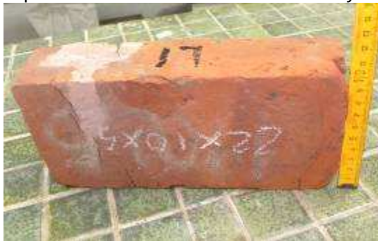
Figura 4 – Ladrillos sometidos a ensayo de capilaridad
