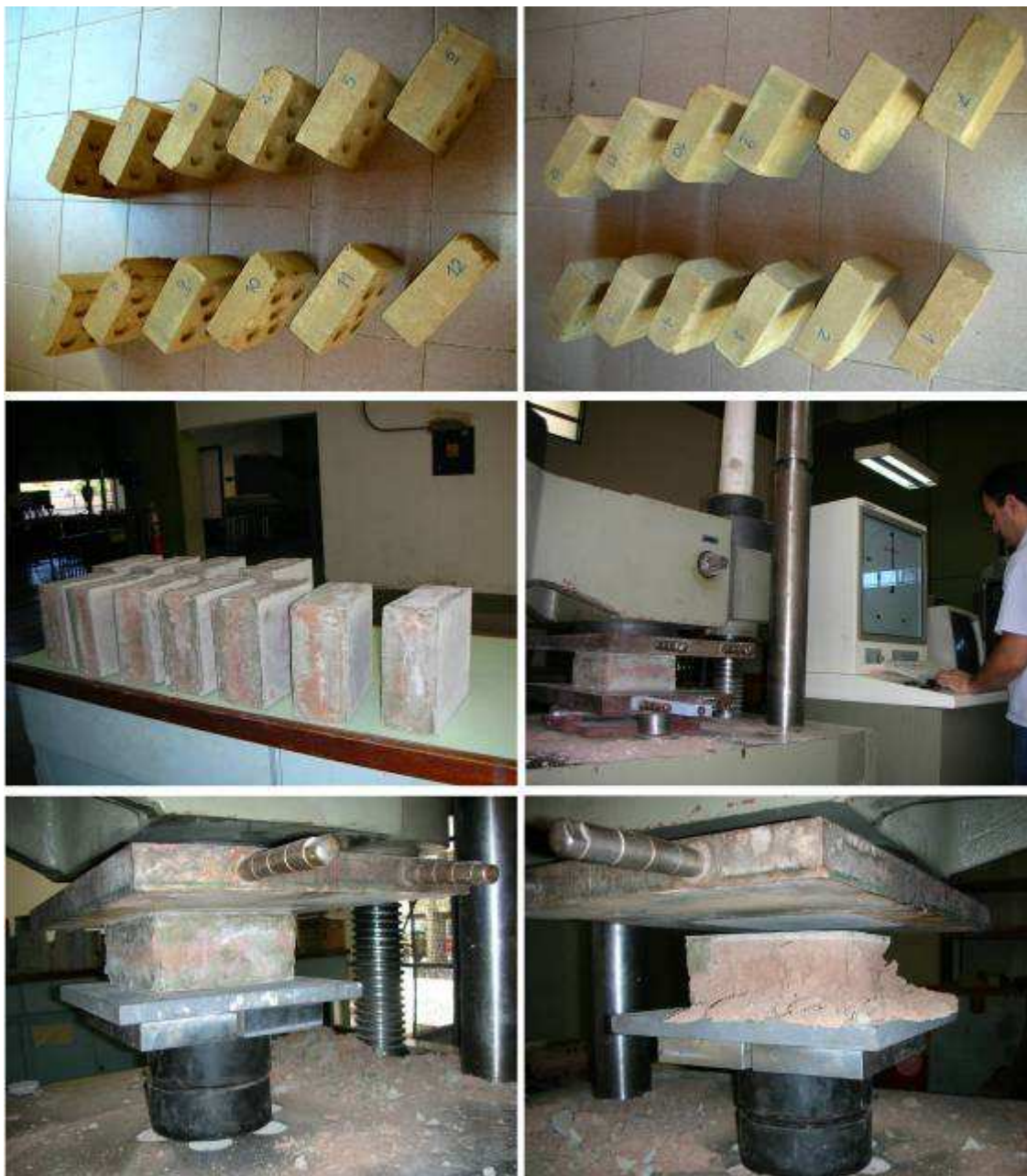
Fig. 3. Arriba: Mampuestos de suelocemento de la segunda muestra. Al medio: Probetas con cabezas preparadas con los mampuestos (Izq.) y equipo de ensayo (Der.). Abajo: ensayo destructivo de la probeta 10.
