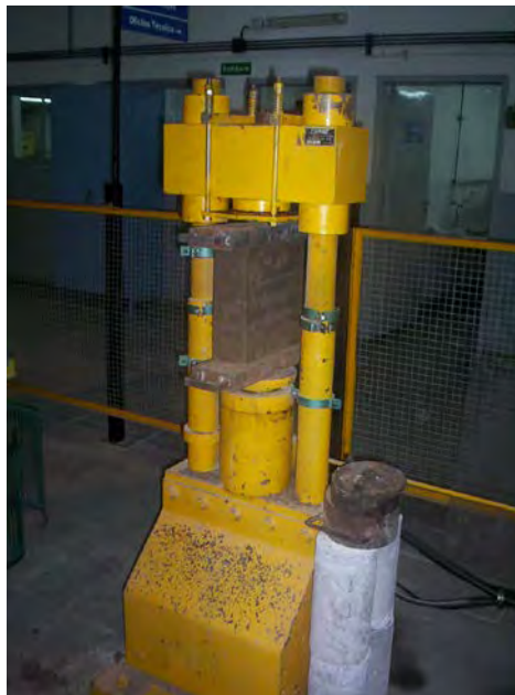
Figura 2. Probeta de suelo estabilizado ensayo a la compresión LEME UTN-FRA (García; Mazzeo, 2010)
