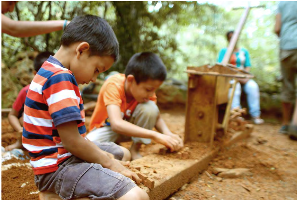
Figura 1. Niños explorando la elaboración de bloques de tierra comprimida con una Cinva RAM
