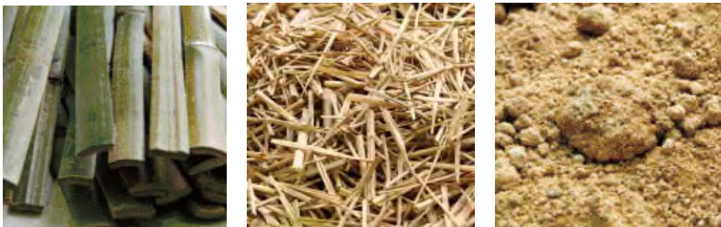
Figura 2: Os três materiais do tsuchikabe
