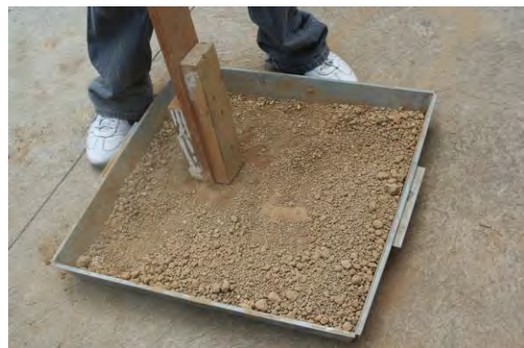
Figura 8. Preparando mezcla para BTC de tepetate estabilizado con cemento.
