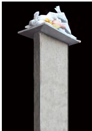
Figura 21 – Prueba de rotura con sacos de arena
