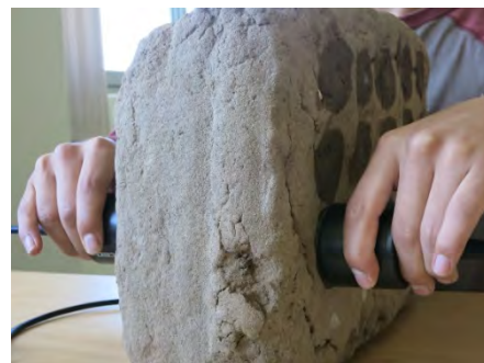
Figura 4. Ensayos de ultrasonido (a) Resultados de onda P para 54 kHz y onda S para 24 kHz y 250kHz (b) configuración de ensayo de tomografía ultrasónica (c) Toma de datos para la tomografía
