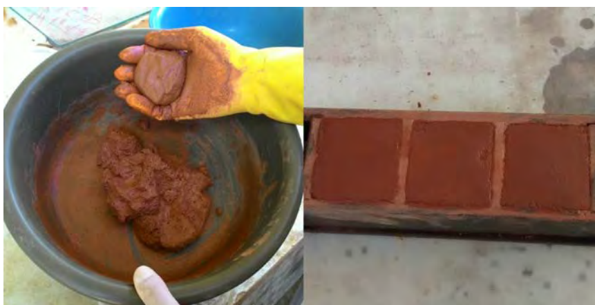
Figura 1. Mistura manual dos materiais e molde cúbico para elaboração dos corpos de prova
