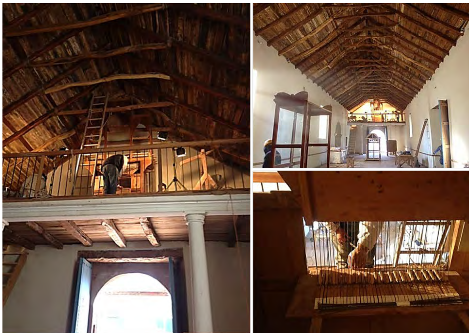
Figura 15. Izquierda: trabajo del Organero Carlos Valdebenito en el altillo del coro de la Iglesia de San Pedro de Atacama en el mes de Julio de 2015. Derecha: ajustes en el sistema de clavijero del órgano (Crédito: Alfaro, 2015)
