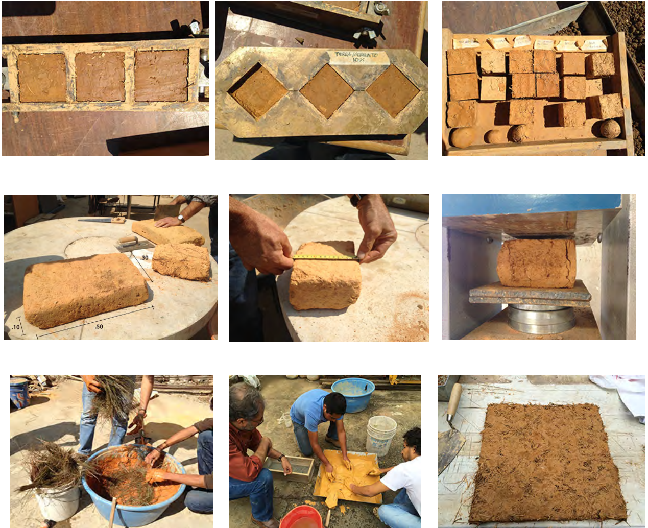
Figura 5. Pruebas técnicas hechas a los adobes de la comunidad y pruebas de "pajarcilla" (combinación de arcilla con paja) con tierra y material orgánico local.
