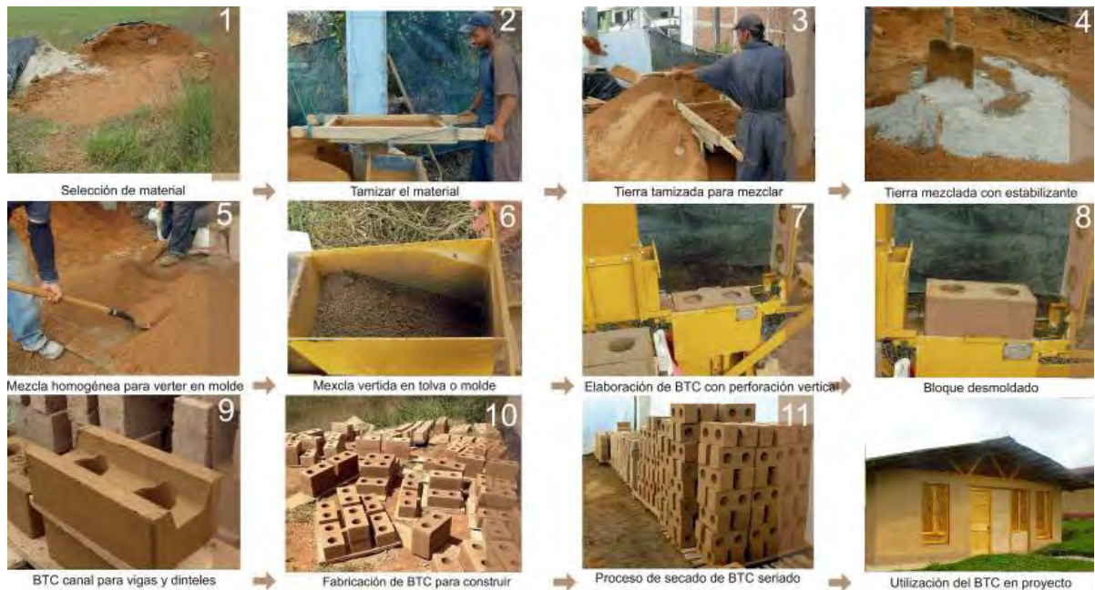
Figura 2. Proceso constructivo BTC
