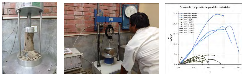
Figura 5. Se muestra los ensayos de compresión y tracción indirecta de cilindros tallados de los adobes hechos con suelo original y también de las muestras del muro original. El gráfico muestra los resultados de ensayos de compresión.
