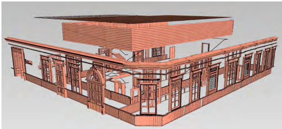
Figura 5. Muestra la totalidad de los elementos de madera a reemplazar por encontrarse afectados por xilófagos, más los revestimientos de madera que dan altura a la Sala de Espectáculos.
