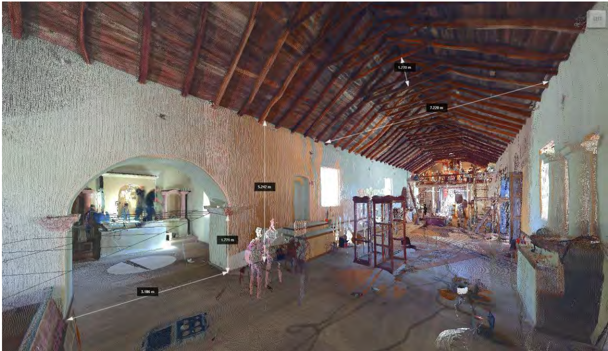
Figura 2. Imagen 3D del proceso de escaneo interior de la Iglesia 3 . (Crédito: Caquisane, 2015)
