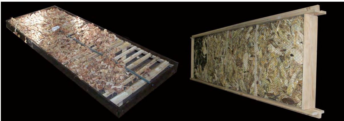
Figura 3 – Imagen del aislante de viruta y pucón
