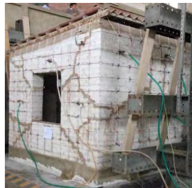
d) Ambiente de adobe reparado y reforzado
