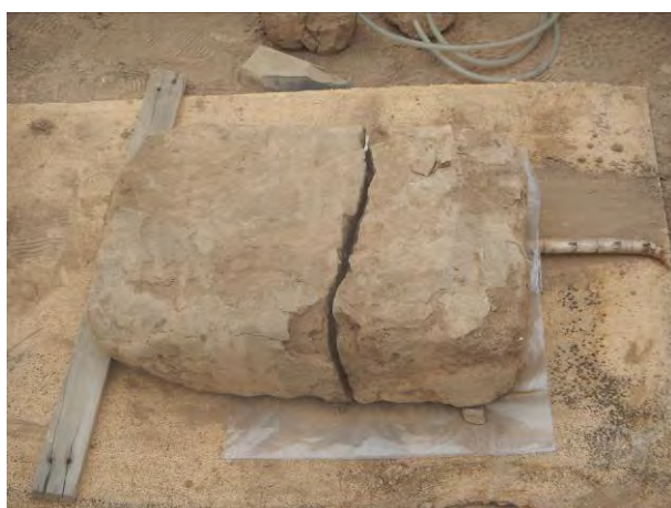
Figura 6 – Reparación de adobes con inyección de barro líquido para los ensayos de flexión
