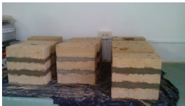
Figura 1. Elaboración de los muretes
