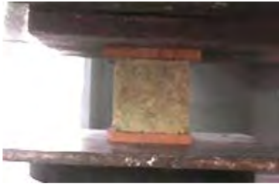
Figura 4. Ensayo de resistencia a la compresión
