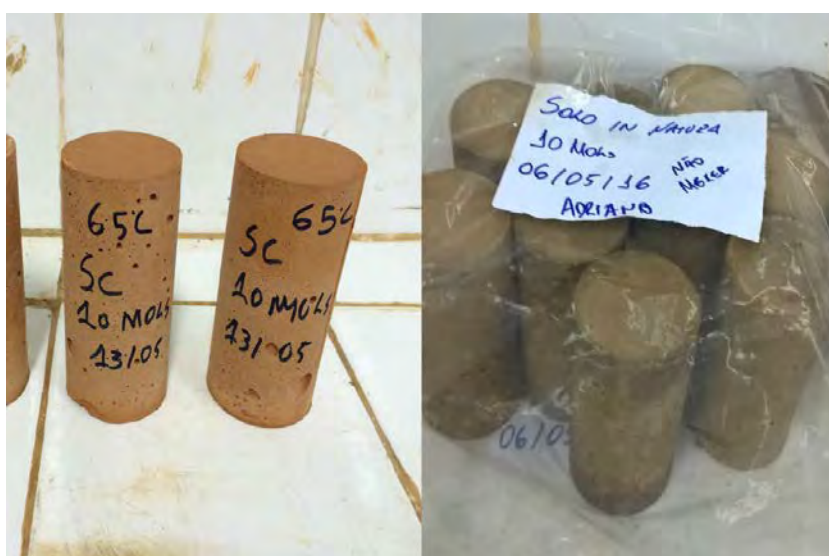
Figura 1 - Corpos de prova cilíndrico de 5 cm x 10 cm e confinamento em saco plástico
