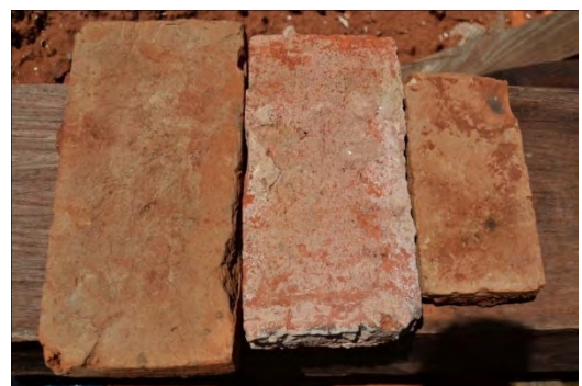
Figura 10. Ladrillos encontrados en el sitio. El primero de la izquierda, de mayor tamaño, es un adobe. El que se observa en el medio es un ladrillo cerámico, caracterizado por su mayor tamaño en comparación al actual ladrillo artesanal, que aparece a la derecha de la foto.
