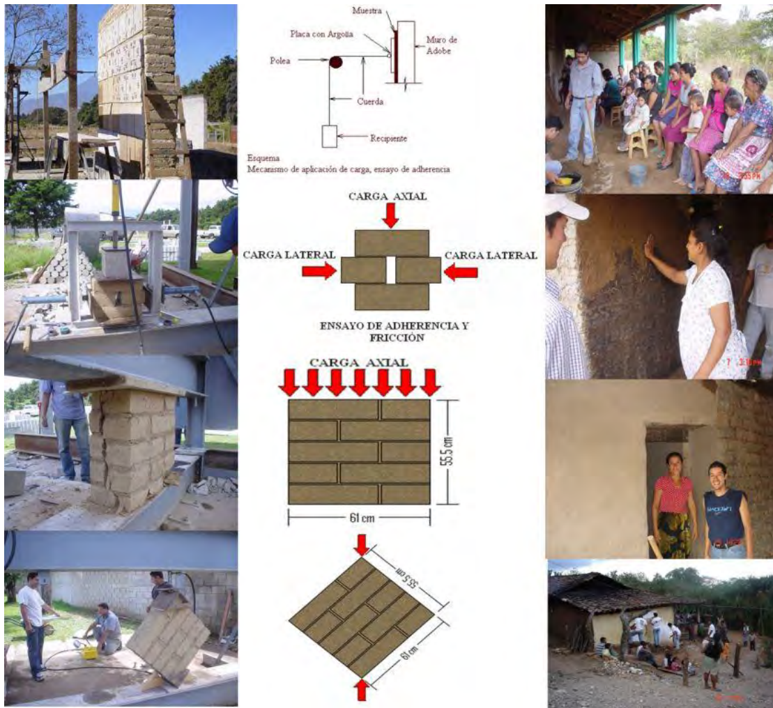
Figura 7. Ensayos de compresión, tracción diagonal y cortante por adherencia y fricción en mampostería de adobe realizados en el Centro de Investigaciones de Ingeniería de la Universidad de San Carlos de Guatemala y transferencia de tecnología en el Departamento de Jutiapa, 2005-2011
