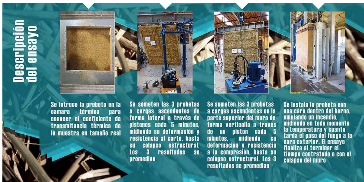
Figura 3: Descripción de ensayos de transmitancia térmica, carga horizontal, carga vertical y comportamiento al fuego
