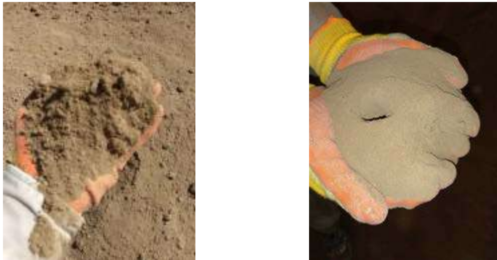
Figura 5: Tierra antes (izquierda) y después de ser procesada (derecha)
