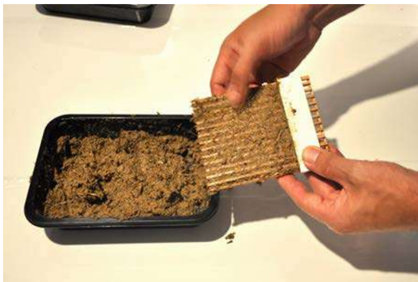
Figura 4. - Relleno en panel de bajareque a escala (crédito: Alejandro Ferreiro)
