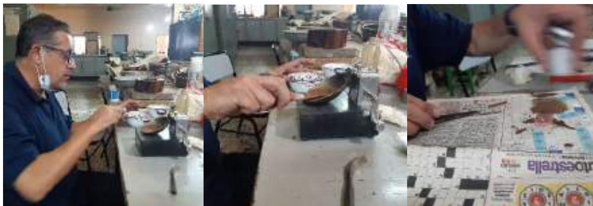
Figura 4. Ensayos en la APV para la determinación de LL, LP e IP
