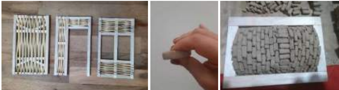
Figura 3: Maquetas de aprendizaje realizados con tutoriales desde el programa online: paneles de quincha prefabricada, pruebas de suelos y bóveda de adobe recargado sin cimbra (fotografías de estudiantes del curso)
