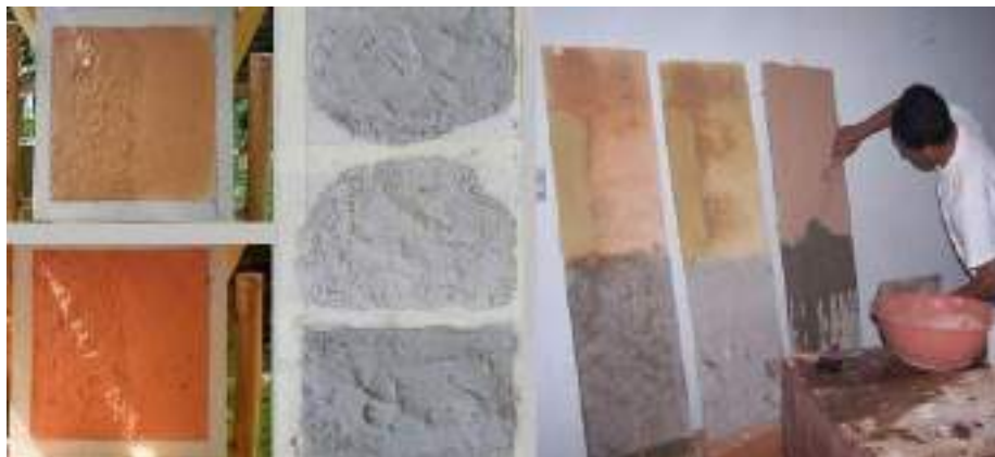
Figura 8. Aplicaciones de muestras de los ecoacabados en placas de fibrocemento, soportes no porosos
