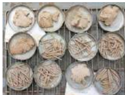
Figura 2. Muestras para determinación del límite plástico
