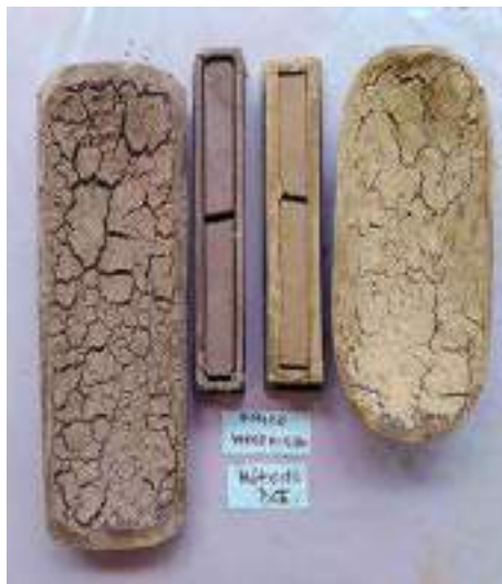
Figura 2. Muestras de tierras aplicando el test BCE y de retracción lineal
