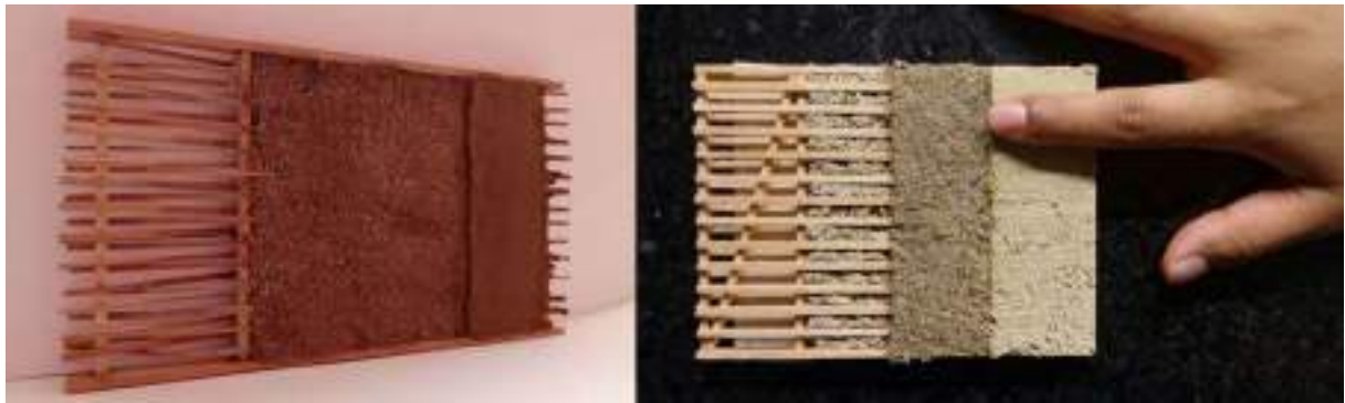
Figura 6. - Arriba: Parte C y D de la ficha taller de bajareque extraído del libro del evento (crédito: Vega, Gabriela). Abajo: tramas y relleno prueba de los participantes del evento (crédito: Apaza, Diana)
