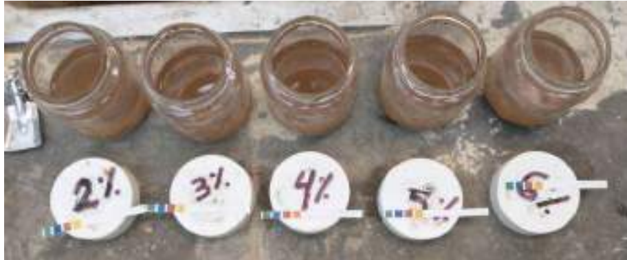
Figura 3. Medición del pH en prueba Eades &Grim (Elena Navarro, 2021)
