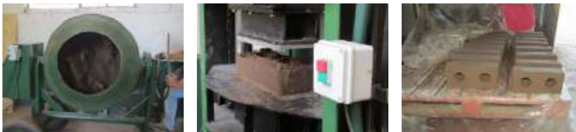
Figura 1: Proceso de fabricación de BTC en la planta de Eco3 Ingeniería: Mezclado de la materia prima; prensado de un bloque y acopio de BTC para ser curados
