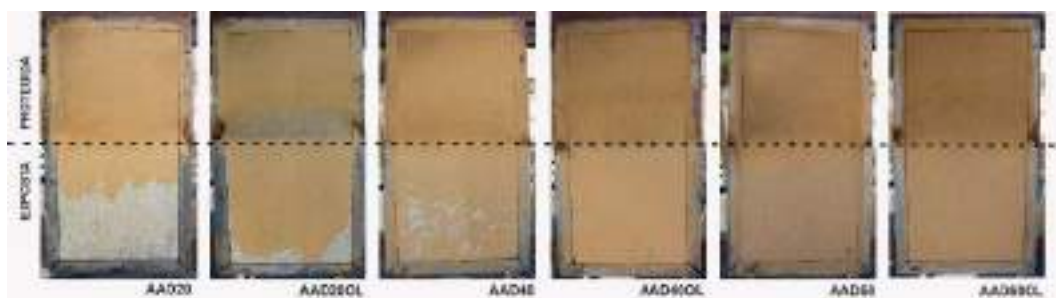
Figura 3 - Aspecto final das pinturas produzidas com o pigmento AAD após 24 meses de exposição ao intemperismo natural
