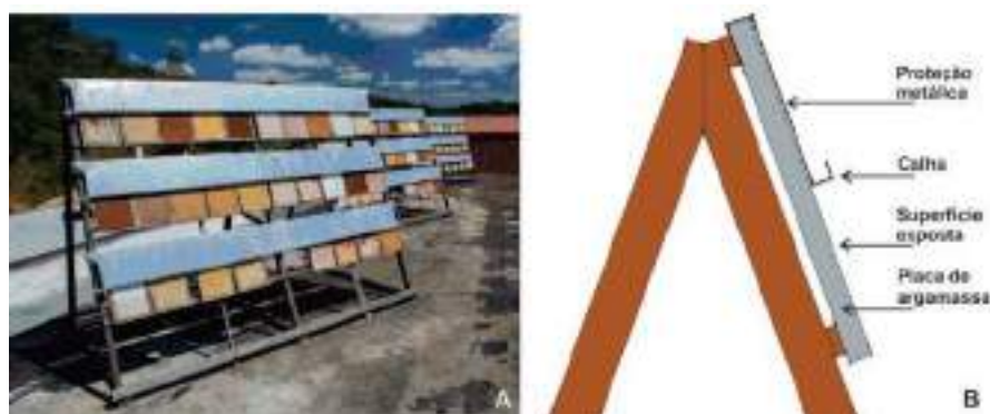
Figura 1 - Estruturas para realização do teste de resistência ao intemperismo natural: A) pinturas expostas ao intemperismo natural; B) detalhe do rack para fixação e exposição das placas de argamassa ao intemperismo natural
