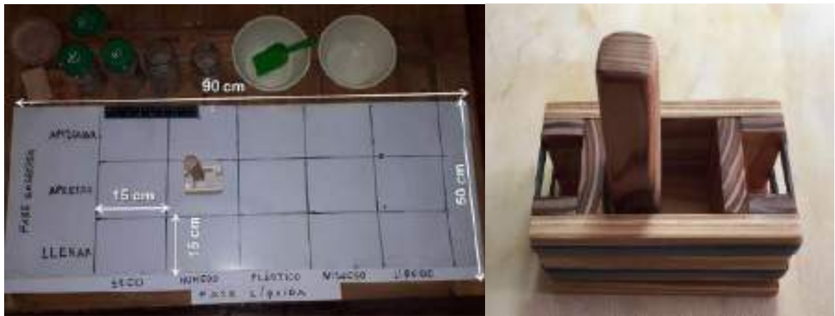
Figura 6. Tablero, implementos, formaleta y apisonador utilizados (Crédito: T. Menepace)
