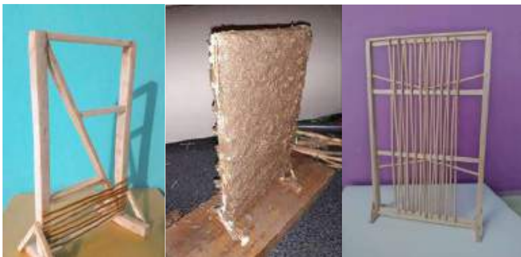
Figura 8. Maquetas a escala de una sección de quincha tradicional y quincha prefabricada (Crédito: S. Quiroga)
