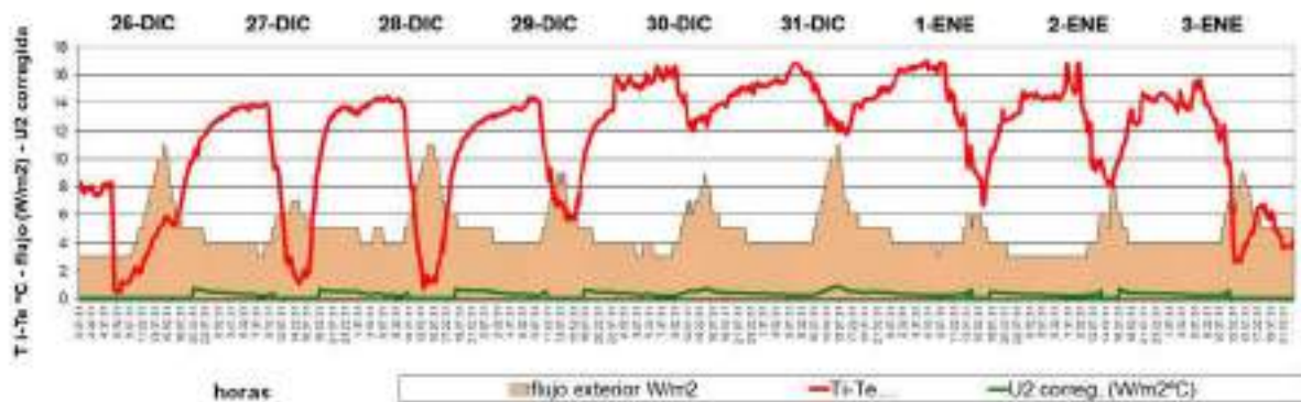
Figura 6. Gráfica Balance temperatura interior y exterior, flujo hacia el interior del muro desde el exterior y U corregida, en el periodo estudiado del 26 de diciembre al 3 de enero.
