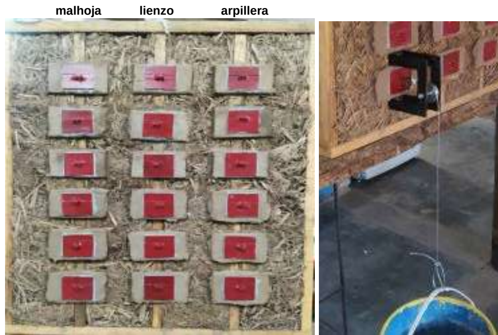
Figura 3. Muestras e instrumental de arrancamiento directo
