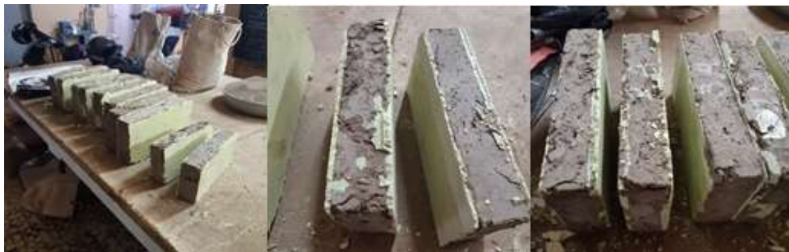
Figura 3. Adobes luego de ser ensayados en la APV, abril de 2021
