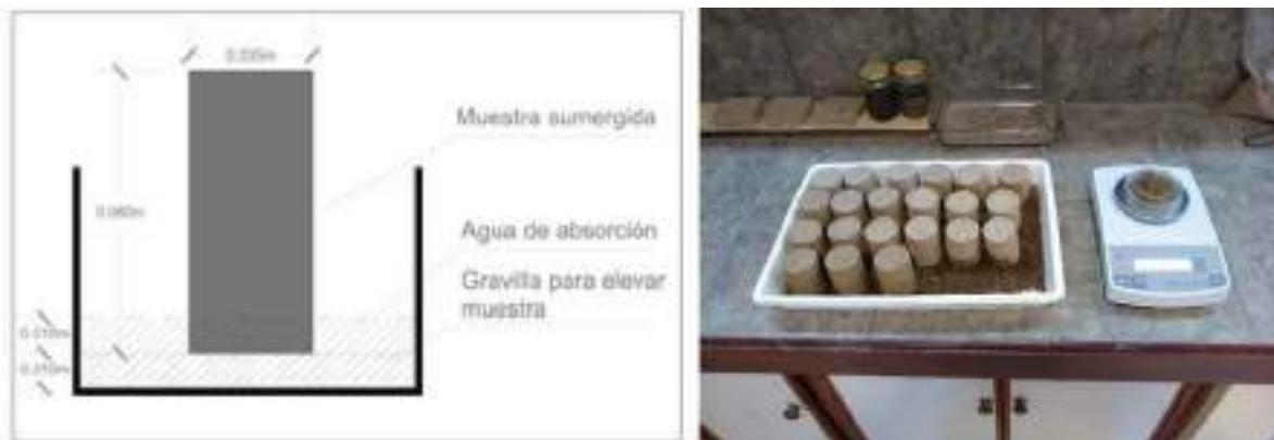
Figura 5. Instrumental para ensayo de absorción de agua por capilaridad
