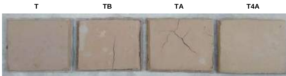
Figura 5. Muestras secas para ensayo de adherencia por golpe
