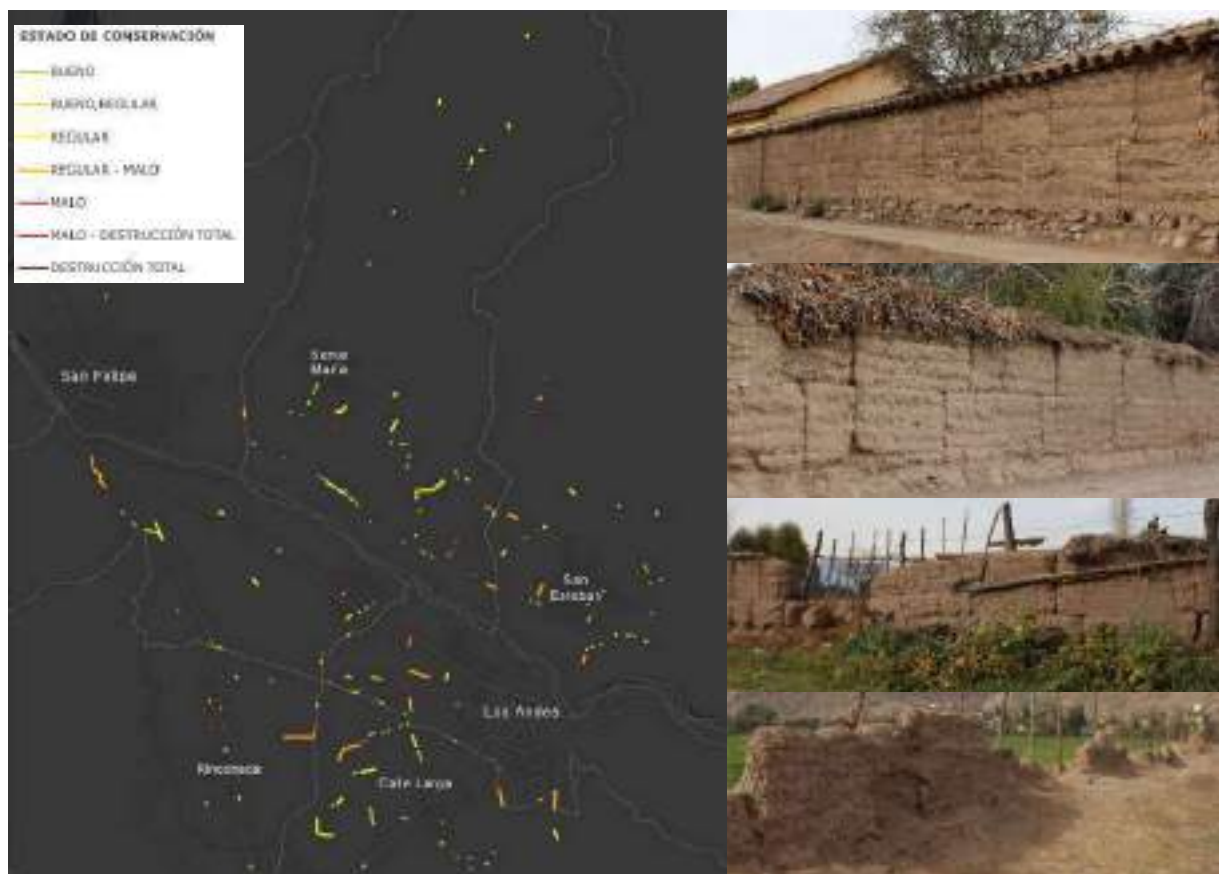
Figura 7. Mapa de estados de conservación y fotografías de las cuatro categorías principales, de arriba hacia abajo: bueno, regular, malo y destrucción total
