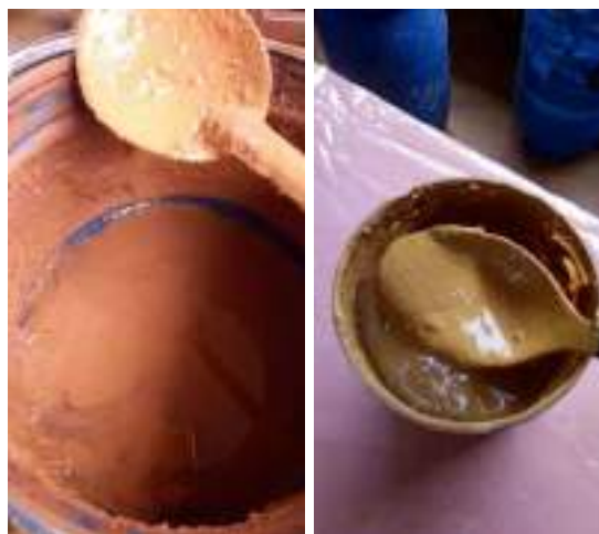
Figura 6. Pigmentos terrosos densos líquidos obtenidos por levigación. Tierras arcillosas colores ocre y amarillos
