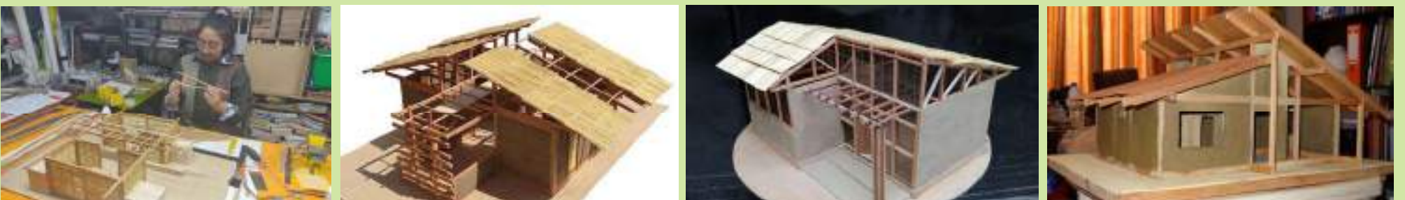
Fig. 5-8. Proceso de diseño de maquetas aplicando la técnica constructiva del bajareque a escala 1:20. Crédito: Vargas,G. Villaverde, D. y Arce C.
