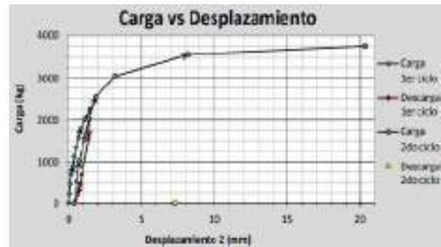
Figura 8. Resultado de los tres ciclos de carga en las pruebas de carga del sistema
