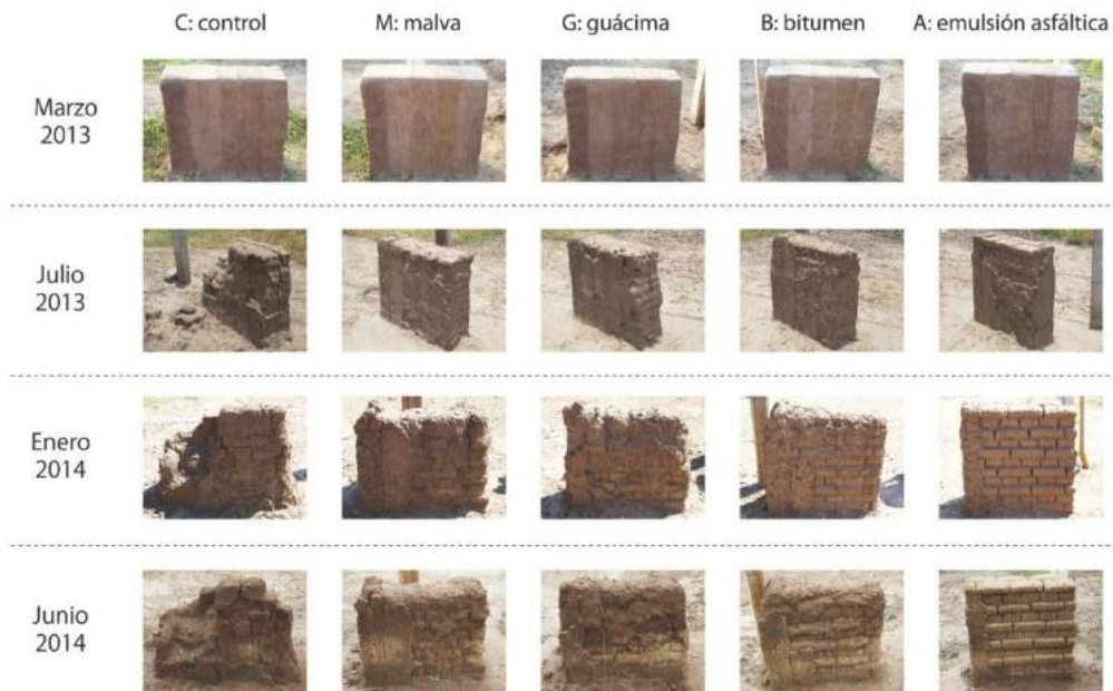
Figura 1. Monitoreo por 15 meses de los muros de prueba de la resistencia a la intemperie (1ª)
