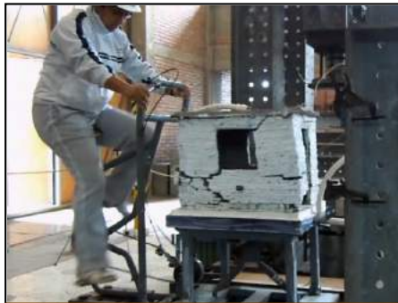
b) Fisuras diagonales
