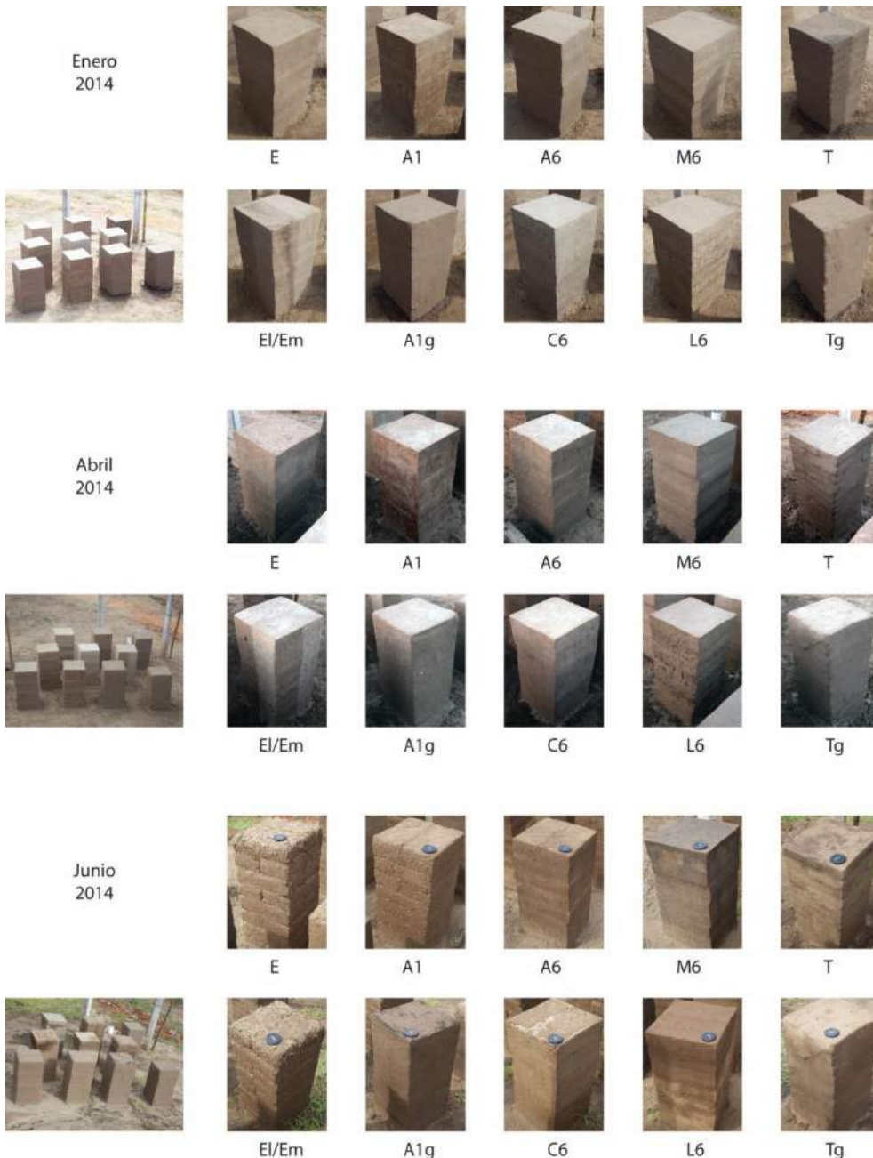
Figura 2. Monitoreo por 6 meses de los muros de prueba de la resistencia a la intemperie (2ª serie).
