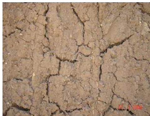
Figura 1. Contracción de revestimiento de arcilla (hospedaje ideal para el vector) Fuente: Quiñónez, F. J., 2009
