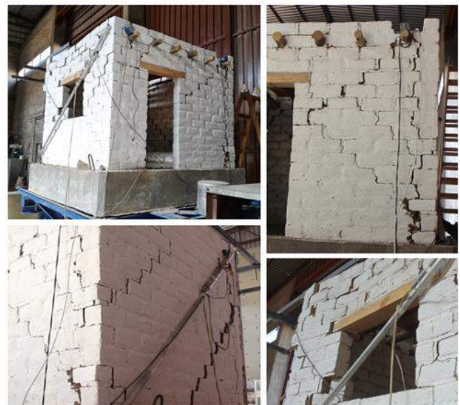
Figura 5. Daños observados al final del ensayo en el modelo sin reforzar.
