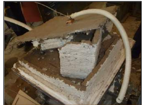
c) Colapso total del modelo sin refuerzo
