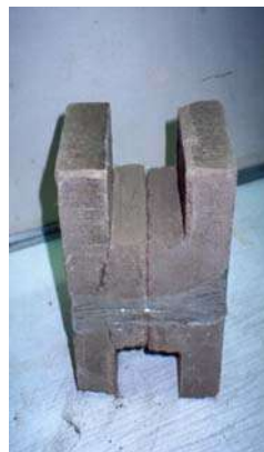
Figuras 14 -15 y 16: Ensayo de Corte Bloques articulados BaTc-II: Orientación de la fractura en cuerpo central.
