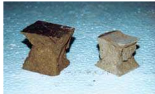
Figura 10: Rotura por compresión en probetas (5x5x14) cm.
