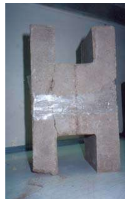
Figuras 14 -15 y 16: Ensayo de Corte Bloques articulados BaTc-II: Orientación de la fractura en cuerpo central.
