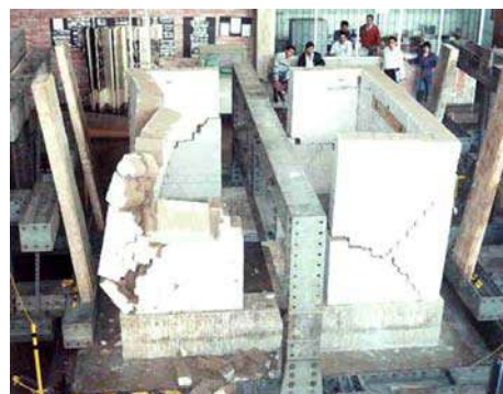
Fig. 17b – Ensayos de muros en U.
