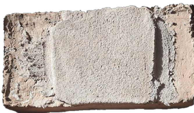
Figura 3. Disposición del revoque sobre el adobe: probeta seca (crédito: A. Rieppi)
