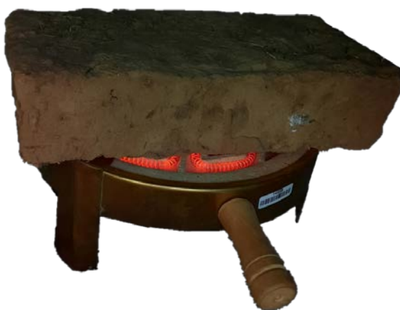
Figura 4. Proceso de ceramización: disposición de la probeta sobre el calentador circular de resistencias eléctricas (crédito: A. Rieppi)
