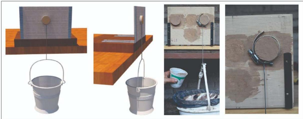
Figura 3. Instrumental para el ensayo de cizallamiento
