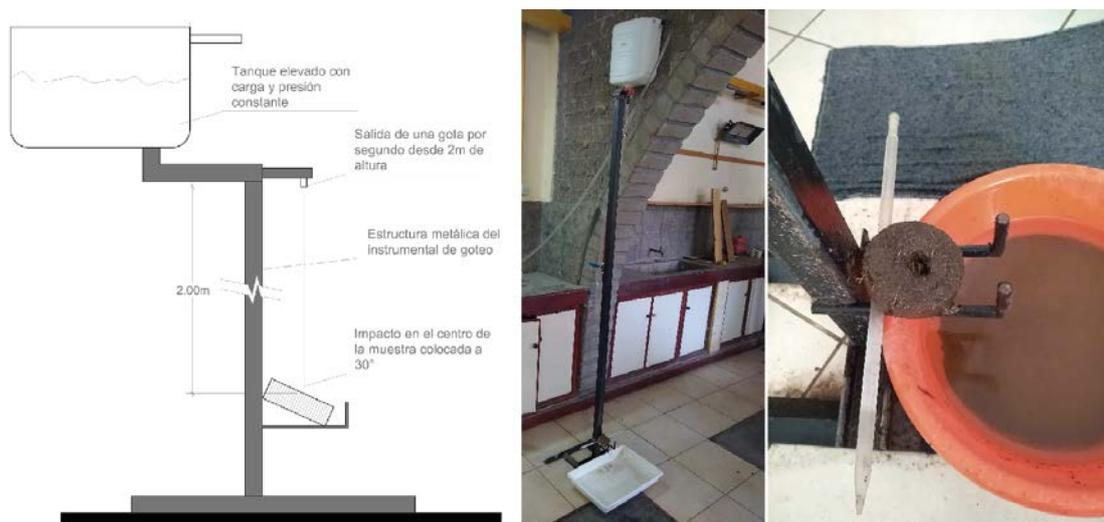
Figura 4. Instrumental para ensayo de goteo
