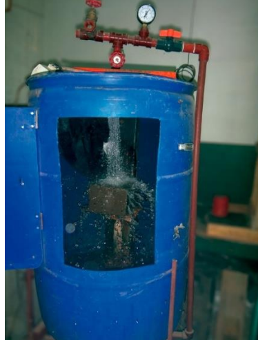
Figura 4. Realización del ensayo de resistencia a erosión húmeda por pulverizador de agua a presión
