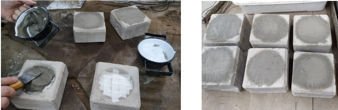
Figura 2. Relleno con mortero del encastre inferior de los medios BTC
