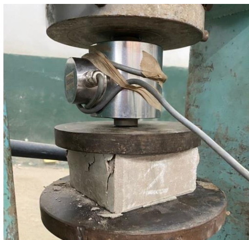
Figura 3. Realización del ensayo de resistencia a compresión sobre una probeta
