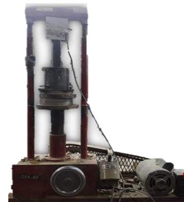
Figura 2.c. Prensa hidráulica de compresión
