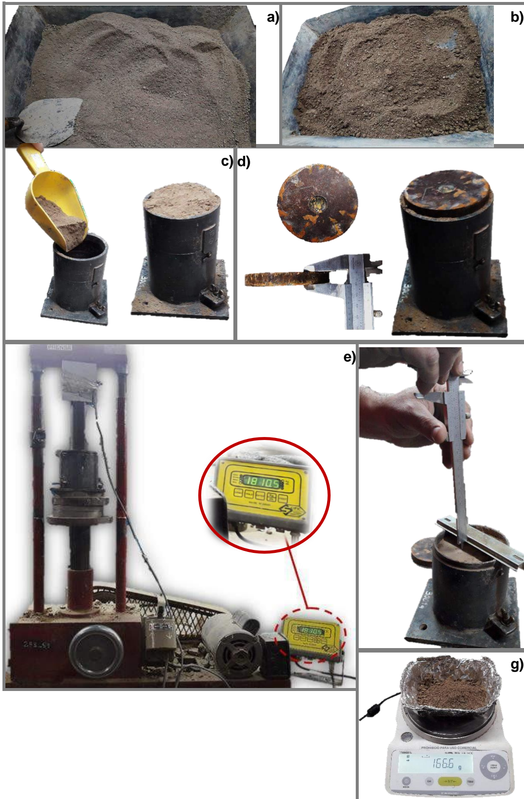
Figura 5. Procedimiento del ensayo Proctor estándar adaptado
