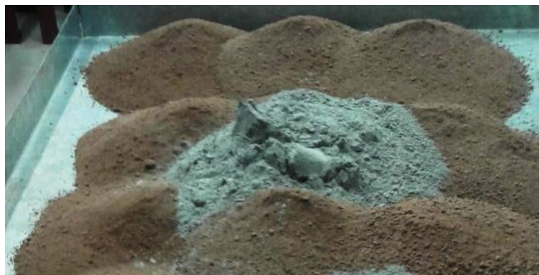
Figura 1. Dosificación volumétrica de la mezcla: 9 partes de tierra y 1 de cemento
