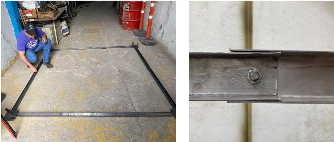
Figura 2. Izquierda: marco metálico base armado; Derecha: detalle de unión de dos L que conforman el marco metálico
