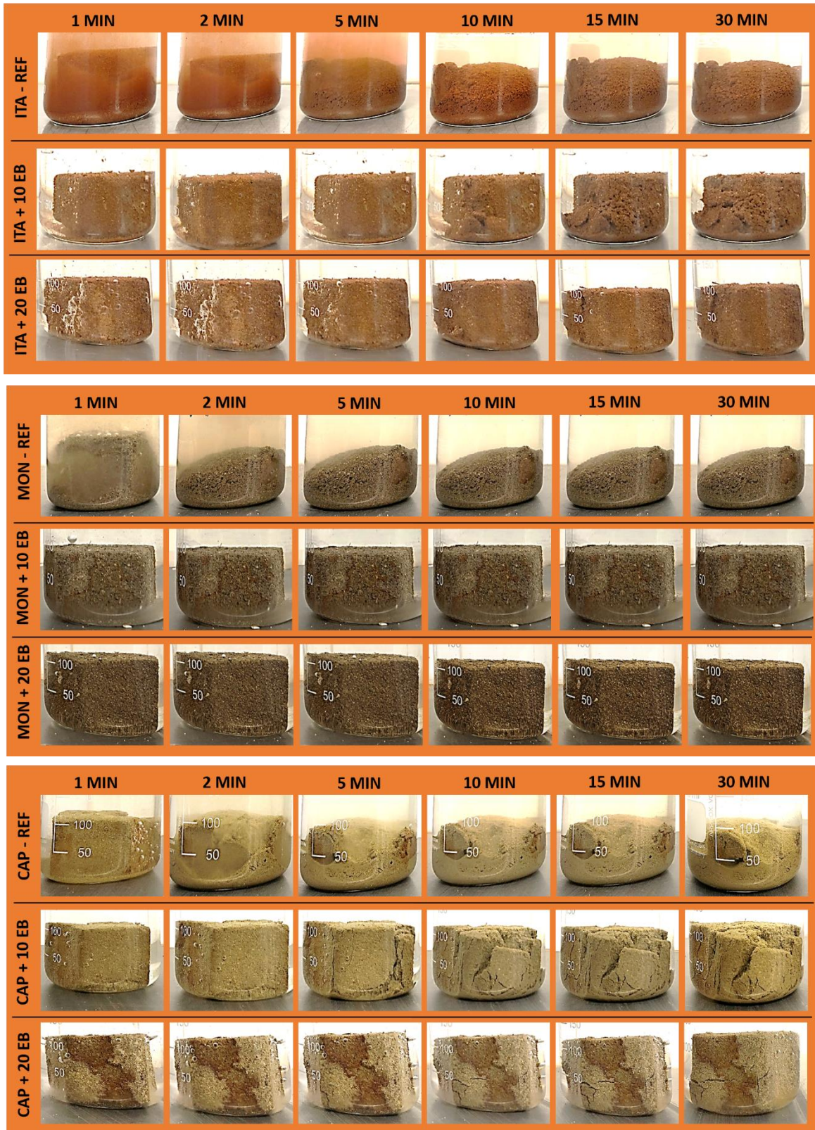
Figura 3. Corpos de provas das argamassas com terra (ITA, MON e CAP respectivamente) com 0%, 10% e 20% de EB em imersão em água até 30 minutos.
