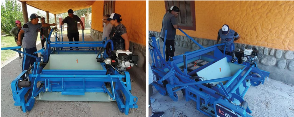
Figura 4. Máquina ladrillera adaptada: 1) tolva para la carga de barro; 2) matriz de moldeado de adobe
