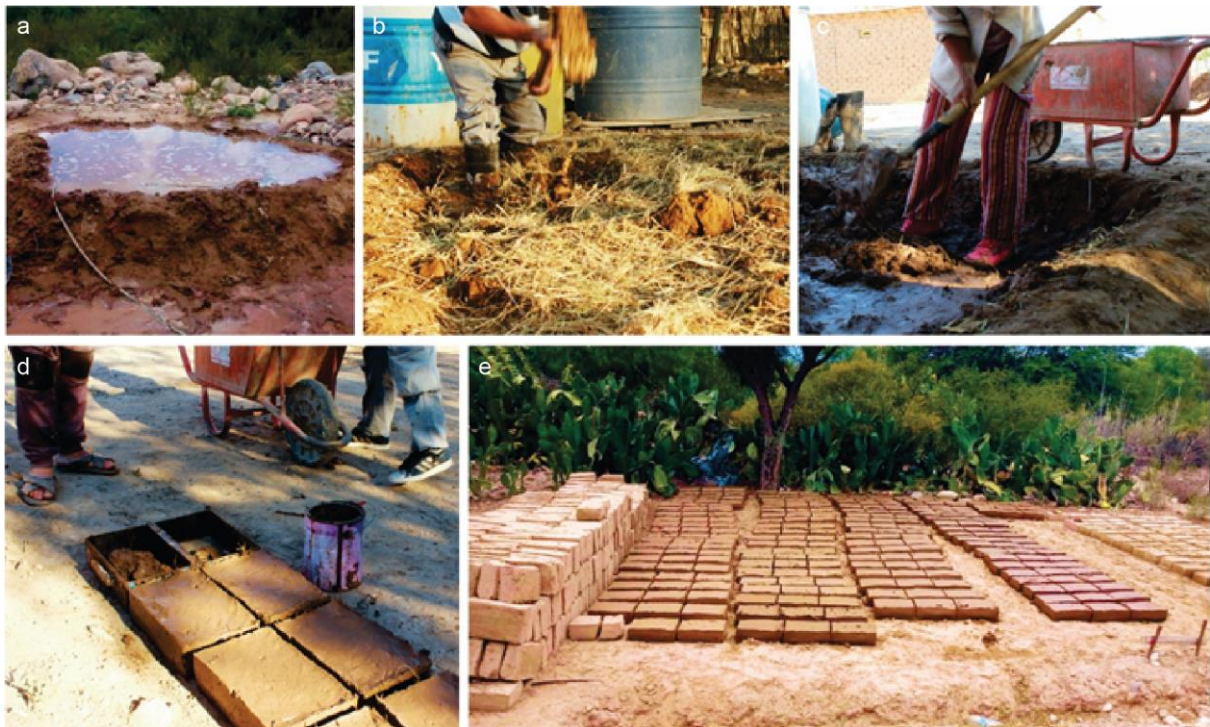
Figura 2. Componentes de planta de producción artesanal. a) preparación del barro. b) agregado de paja durante el mezclado. c) mezclado manual. d) moldeado. e) cancha con producción de adobes
