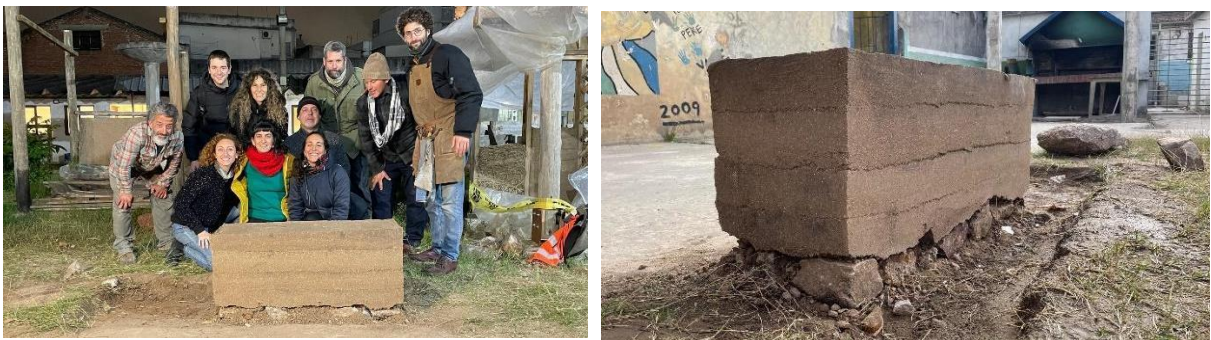
Figura 8. A la izquierda, finalización del prototipo ejecutado en el tercer taller, mayo de 2024. A la derecha, el mismo prototipo luego de dos semanas de su ejecución
