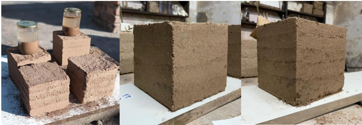
Figura 5. Muestras de pruebas de dosificación – compactación. (crédito: C. Briño y C. Varin)
