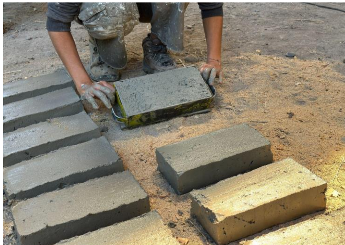
Figura 4. Lugar de las prácticas de escuela DeBarro con la práctica de corte de adobes
