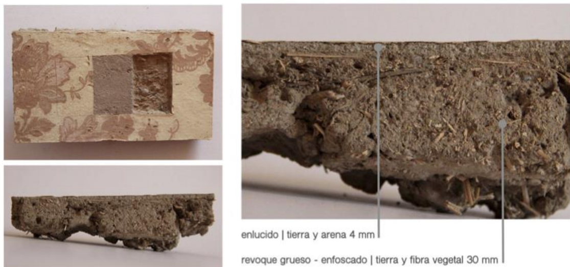
Figura 3. Muestra de acabado interior de la casa de la familia Contreras en Carén (CAR02D). Arriba: muestra completa (13 x 18 cm) con levantamiento estratigráfico que muestra las diferentes capas de revoque de tierra y papel mural. Abajo y derecha: sección que muestra 4 mm de revestimiento de tierra y arena (enlucido) y 30 mm de yeso enfoscado con tierra y fibra.
