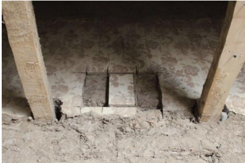
Figura 2. Extracción de una muestra (13 x 18 cm) del muro de adobe de una casa en Carén (CAR02D)
