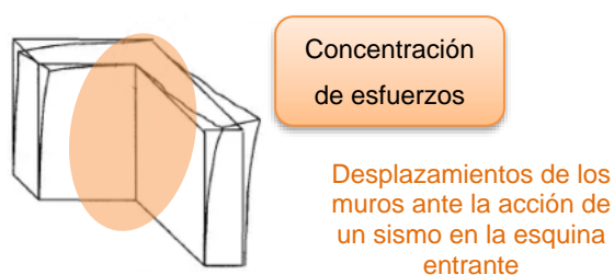
Figura 4. Comportamiento muros y esquinas entrantes vulnerables por la concentración de esfuerzos
