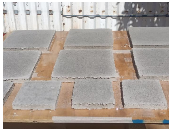
Figura 5. Arcilla / Papel de diario / Mezcla con serrín / Probetas secas
