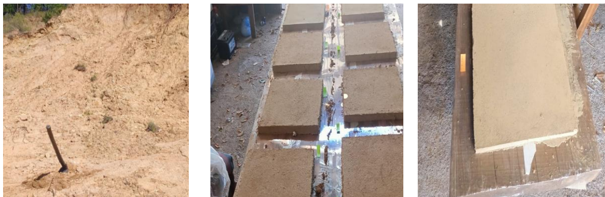
Figura 1 Cantera de tierra / Probetas de revoque grueso / Probetas de revoque fino
