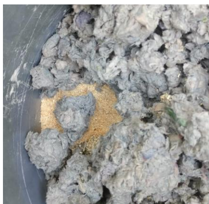
Figura 5. Arcilla / Papel de diario / Mezcla con serrín / Probetas secas
