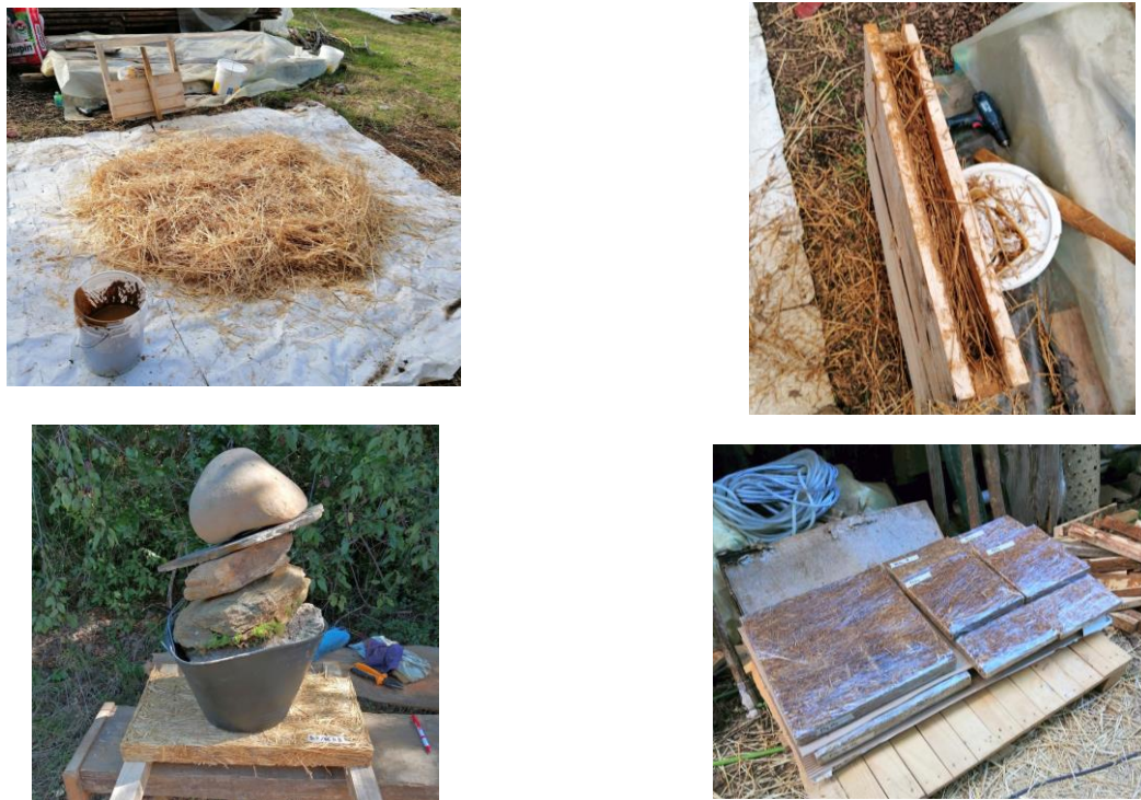
Figura 4. Materia prima y molde / Ejecución de probeta / Prueba de resistencia / Probetas ejecutadas
