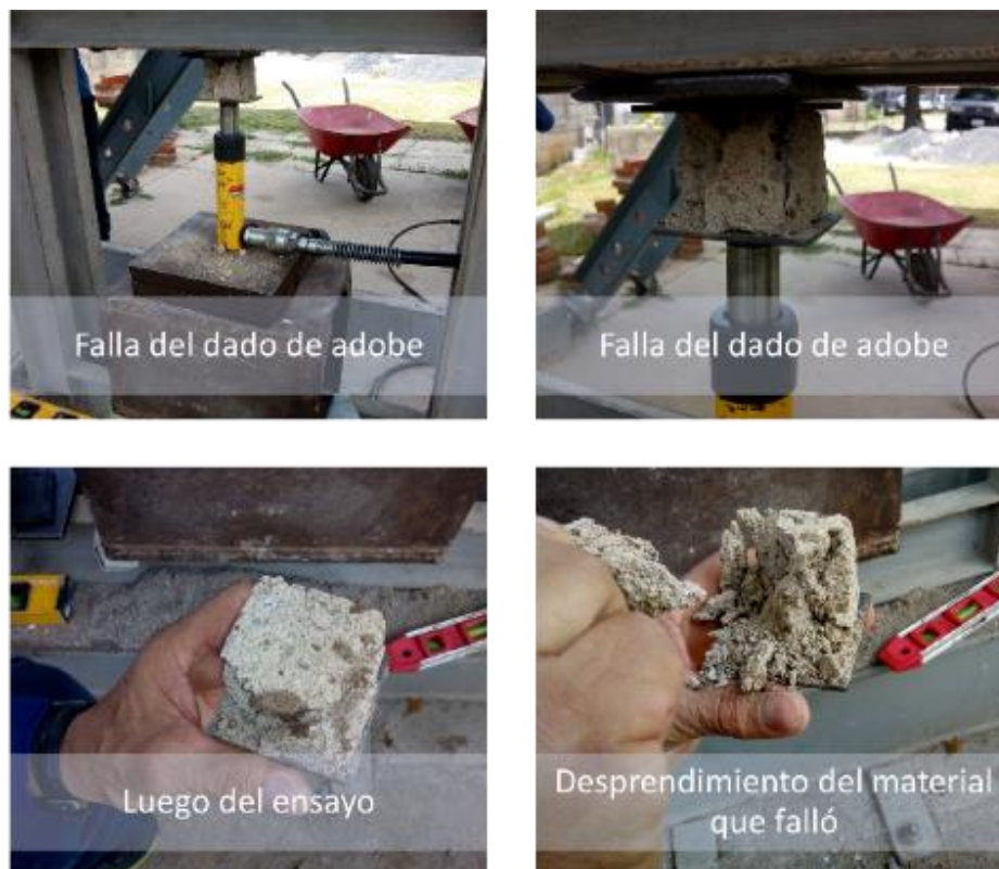
Figura 8: Ilustración del proceso de ensayo a compresión para el dado de adobe configurado 1.
