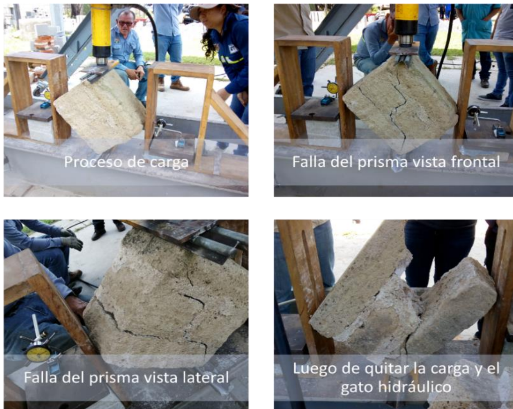
Figura 2: Ilustración del proceso de carga del sistema de ensayo a corte de los prismas de adobe (tipo SC-1) en la Sección de Estructuras en la Universidad de San Carlos
