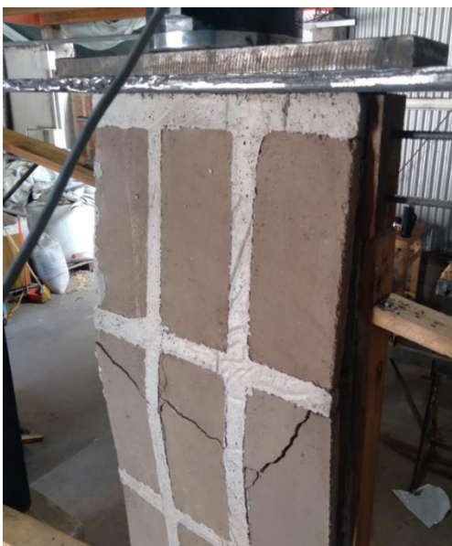
Figura 5. Rotura a la compresión del muro BENO construido con bovedillas-BTC (ambas fotos corresponden al mismo ensayo)
