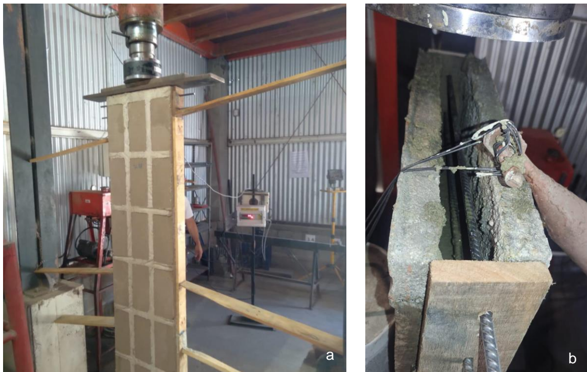
Figura 3. Armado del muro BENO con bovedilla-BTC en la zona de prensado: a) muro BENO con bovedilla-BTC armado en la prensa; b) armado de la viga de encadenado
