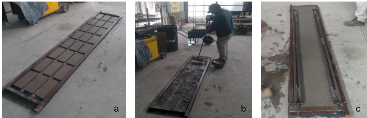
Figura 2. Secuencia de fabricación de la placa BENO: a) distribución de las bovedillas-BTC en el molde; b) barrido con mortero de unión; c) colocación del molde colado de los nervios de la placa
