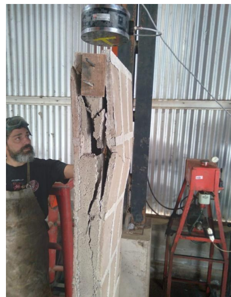
Figura 5. Rotura a la compresión del muro BENO construido con bovedillas-BTC (ambas fotos corresponden al mismo ensayo)
