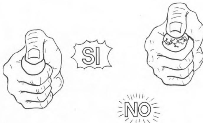
Figura 2. Prueba de campo de presencia de arcilla o tracción indirecta.
