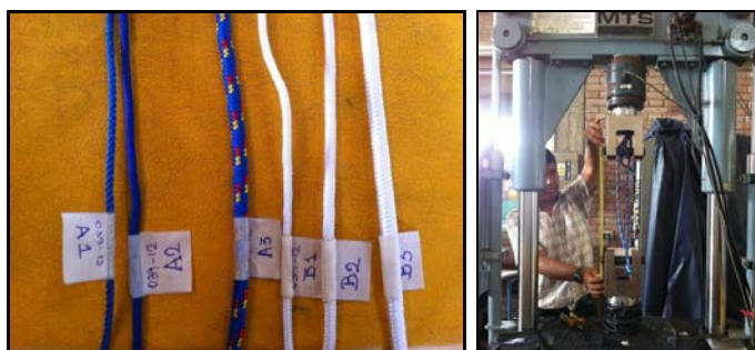
Figura 6. Cabos o drizas sintéticas, ensayadas en el laboratorio de la PUCP
