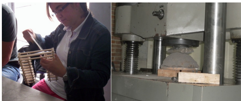
Figura 1. Elaboración de modelos y falla en laboratorio
