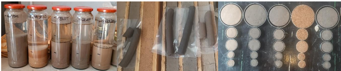
Figura 1. Prueba de sedimentación, prueba del rollo y prueba de la pastilla
