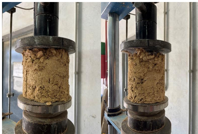
Figura 2. Probetas de compresión simple durante el ensayo y posterior a él donde puede observarse la recuperación de la muestra.
