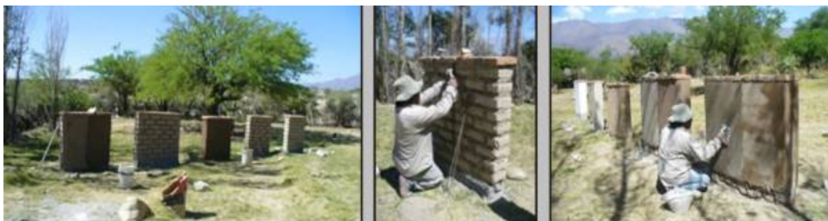
Figura 3. Muretes realizados con materiales y mano de obra local y expuestos al clima del lugar para verificar su comportamiento a la intemperie.
