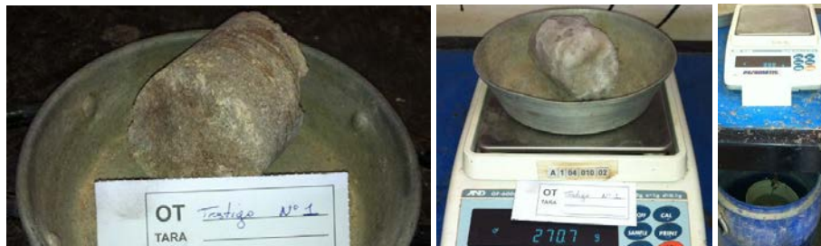
Figuras 9. Izquierda: Testigo para determinación de densidad. Figura 10. Centro: Testigo recubierto con cera de parafina. Figura 11. Derecha: Derecha, Obtención del peso sumergido
