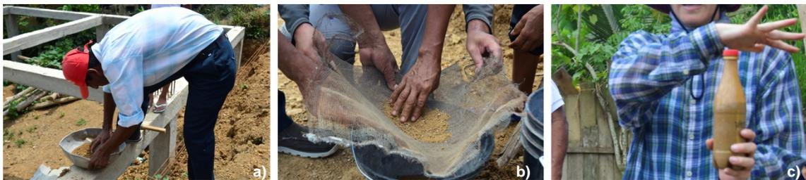
Figura 3. Prueba de granulometría: a) recolección de tierra; b) tamizado; c) prueba de botella (acervo Ensusitio)
