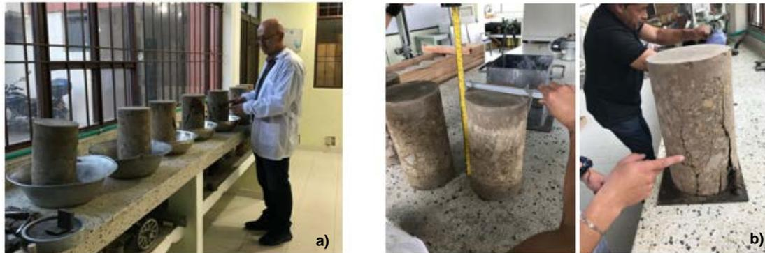
Figura 4. Extracción y preparación de probetas a) ensayo de compresión inconfiada de la tapia; b) medición de altura y diámetro antes y c) después del ensayo (crédito: W. Castillo)
