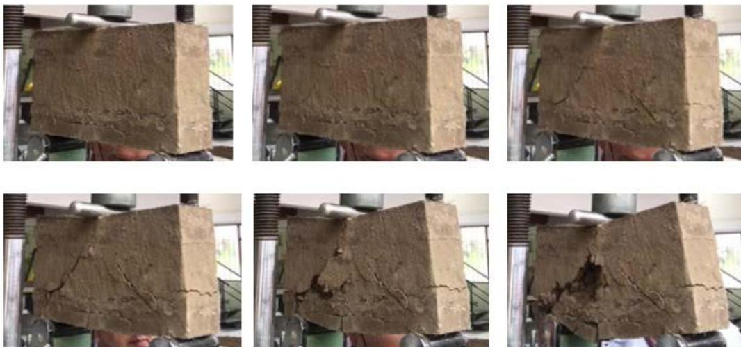
Figura 10. Secuencia de falla de la probeta de la viga con pañete reforzado. Muestras Joaquín María Pérez (crédito: W. Castillo)
