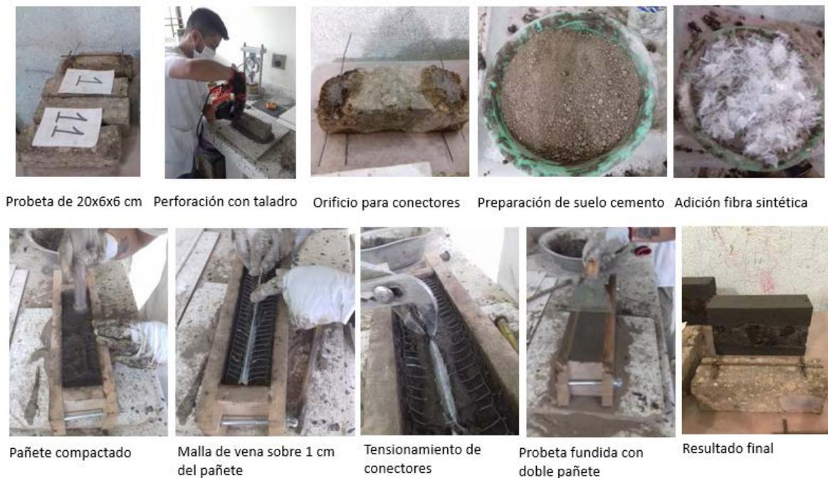
Figura 9. Proceso constructivo de refuerzo con pañete de la viga de tapia (crédito: W. Castillo)
