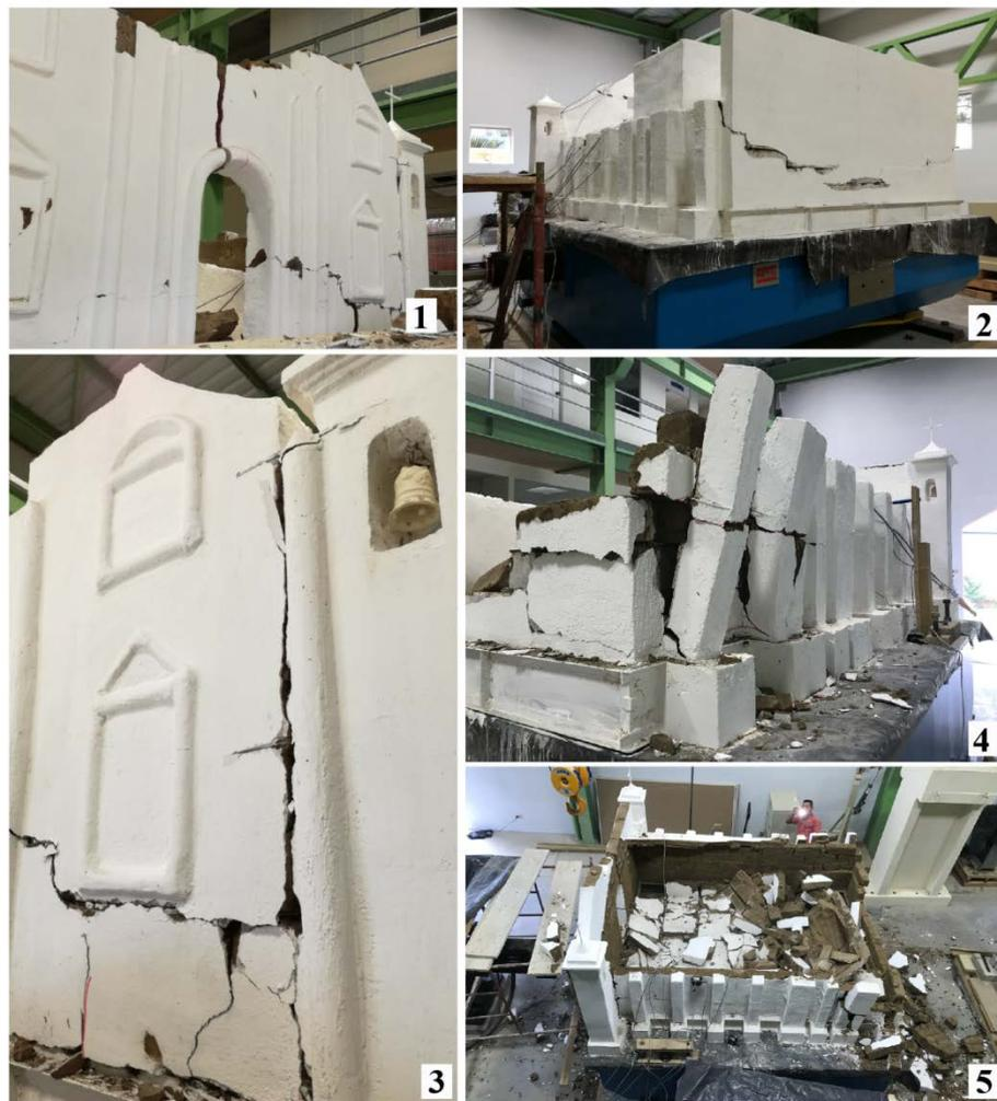
Figura 6. Daño a la fachada (1), grietas en la pared posterior (2), colapso de la parte superior de la fachada (3), daños a la pared debido a la presión lateral (4) y colapso de la bóveda (5).
