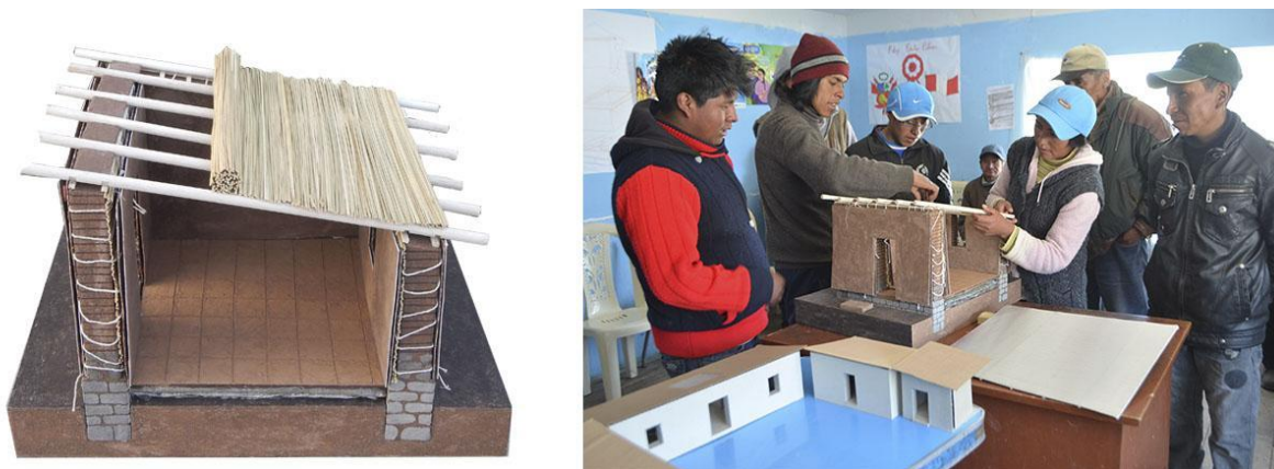
Figura 6. Maqueta constructiva desarmable.
