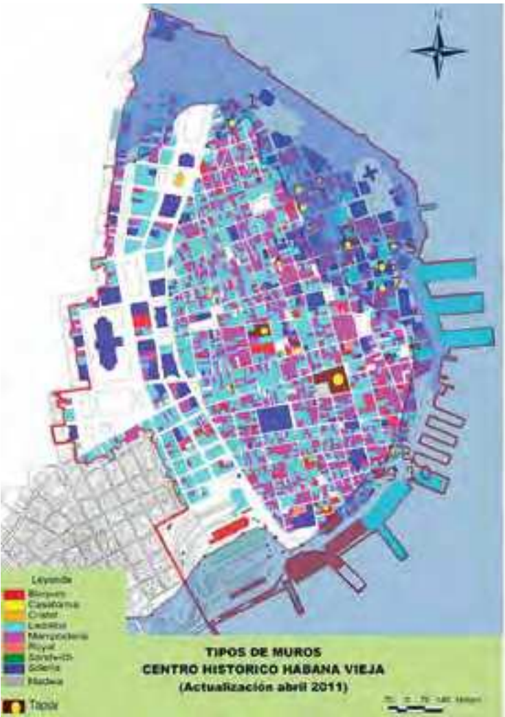
Fig.2 Inventory of wall types, and primary and secondary flooded areas in Old Havana; yellow circles reveal rammed-earth construction (credits: Rodriguez, 2011 - Plan Maestro de la oficina del Historiador de la Ciudad de la Habana, Dirección de Planificación Física Ciudad Habana y CITMA Ciudad Habana, 2006-2011)
