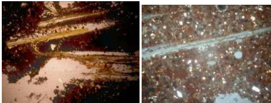
Figuras 6 y 7 - Fotomicrografías de Adobes del ExConvento de San Juan Bautista Tiripetío, Michoacán, México, Primera Escuela de Altos Estudios de América. Microscopía de Luz Polarizada Transmitida en Microscopio Petrográfico, Secciones Delgadas elaboradas en la Universidad Autónoma de Barcelona, España, Descripción cortesía del Dr. Aurelio Álvarez y Pérez, Proyectos AECID A/010109/07 y A/016426/08. Fotografía 6, 4x NP Detalle de las fibras vegetales.
