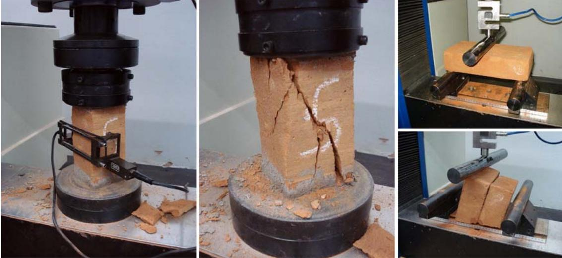
**Fig. 2** - Alguns aspectos dos ensaios de determinação do módulo de elasticidade, notando-se o dispositivo de medição de deformações (extensômetros eletrônicos EMIC) e o padrão de ruptura dos CPs (à esquerda); determinação do módulo de ruptura na flexão (à direita).
