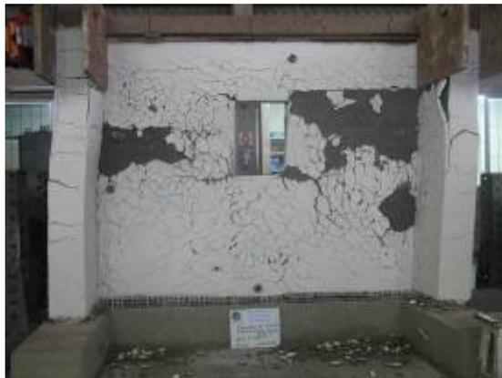
Figura 6 – Aspecto de muro reforzado tras haber sido ensayado bajo carga cortante cíclica
