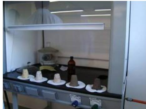
3. Condiciones artificiales de calor: 100 °C y 800 °C
