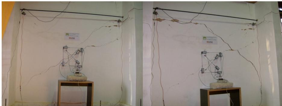
Fig. 1 - Início da fissuração (Pereira, 2008); Fig. 2 – Propagação e formação de novas fissuras (créditos: Pereira, 2008).
