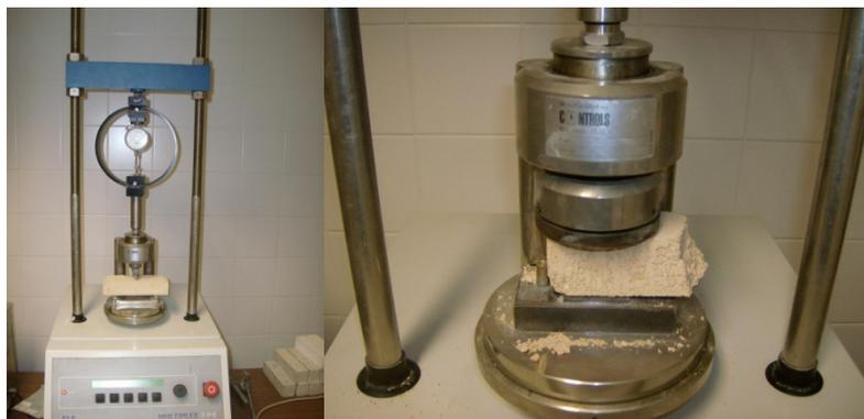
Fig. 6 – Ensaio de flexão; Fig. 7 – Ensaio de compressão (créditos: autores 2009).
