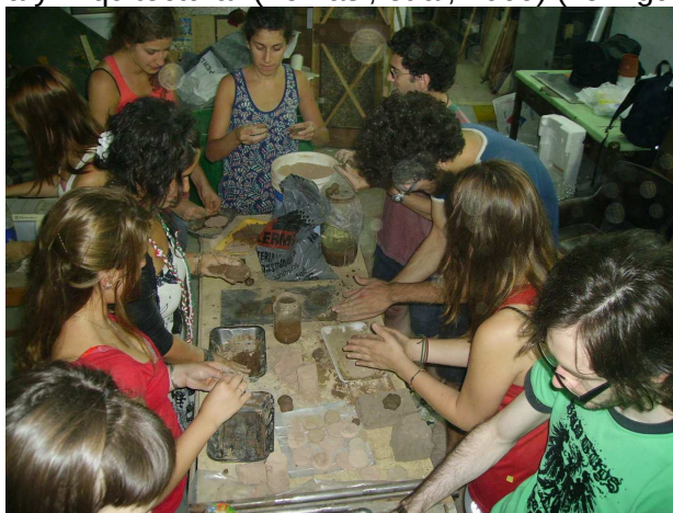
Figura 1: Formación en investigación de alumnos de los últimos años de la carrera Arquitectura en la FADU-UBA, Buenos Aires. Ensayos sensoriales, contracción lineal, evaluación y lectura de ensayos en aula-laboratorio. 2008.
