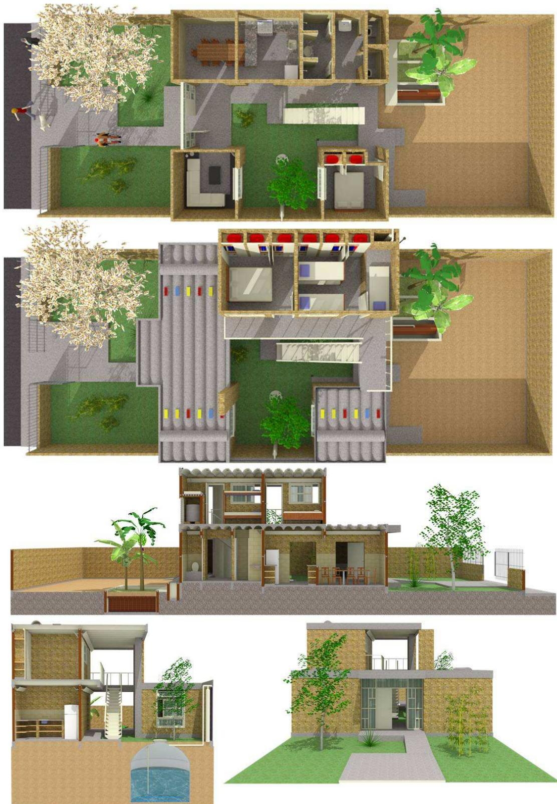
Fig.3 – Plantas baixas, cortes e fachada. Térreo: hall de entrada; sala de estar; copa/cozinha; banheiro; área de serviço; quarto; escada; pátio com cisterna; e canteiro bio-céptico (fundos). Pavimento superior: quarto casal; quarto triplo (beliche acima dos reservatórios para captação das águas das chuvas). Nas coberturas é possível ver os vãos de iluminação (vidros coloridos) e algumas cascajes cobrindo os vãos de ventilação (créditos, Buson, 2010).
