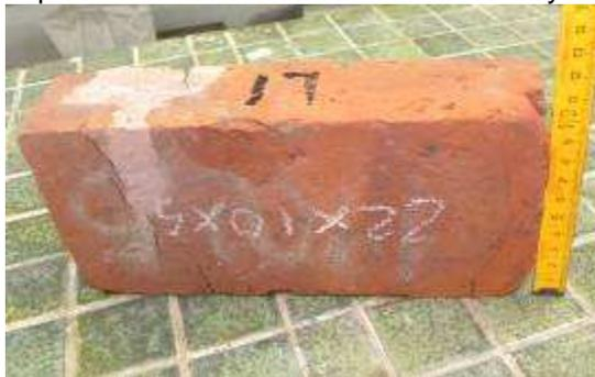
Figura 4 – Ladrillos sometidos a ensayo de capilaridad
