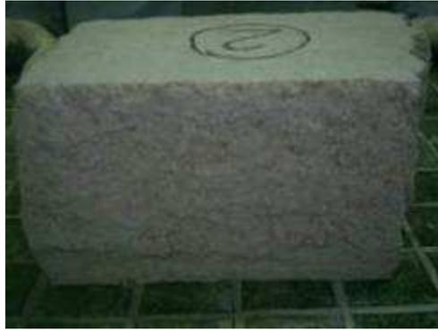
Figura 2 – Muestras testigo sometidas a ensayos de humedecimiento y secado
