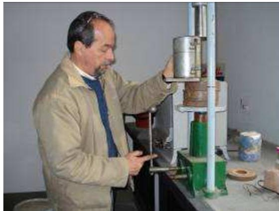
Foto preparación ensayo Proctor
