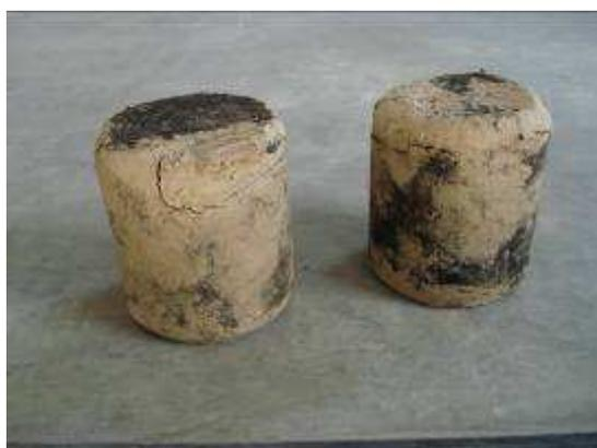
Foto probetas ensayadas a absorción de agua
