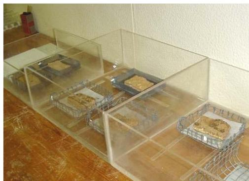
1. Amostras em tinas – processo de absorção de água
