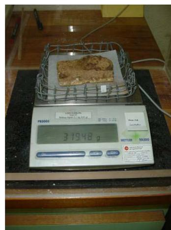
2. Pesagem durante o processo de absorção de água
