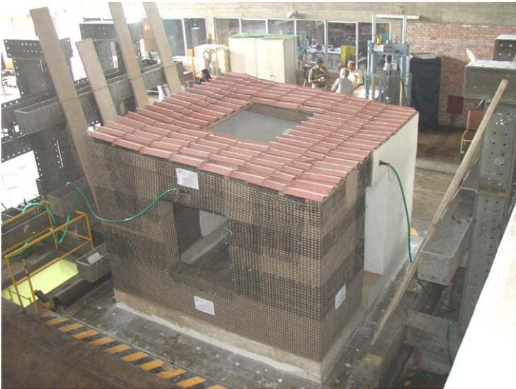
Fig. 4 - Módulo reforzado con malla exterior de plástico
