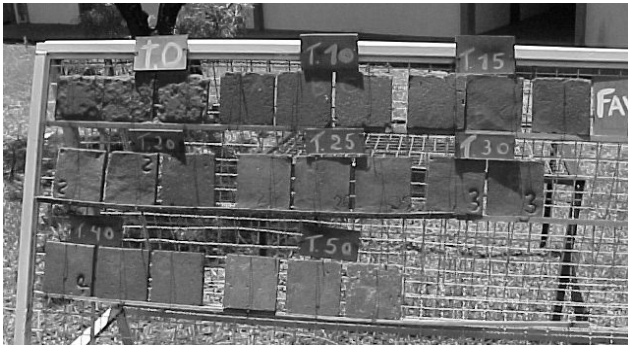
Figura 04- Esquema geral da bancada de envelhecimento do ensaio de intemperismo.
