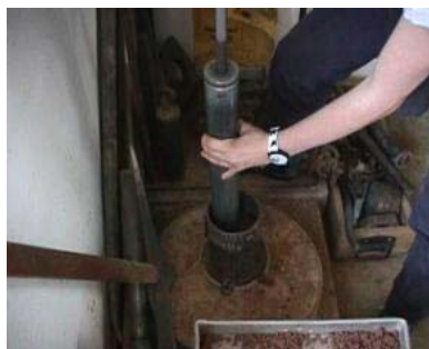
Fig.3 – Molde pequeno e pilão leve (ensaio Proctor)
