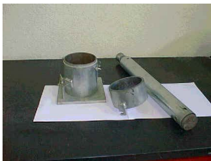
Fig.3 – Molde pequeno e pilão leve (ensaio Proctor)
