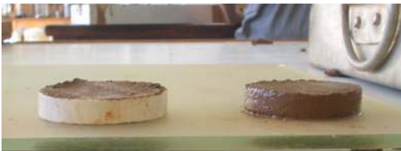
Figura 1. Moldagem das pastilhas para os ensaios de resistência do solo seco e Desagregação do Solo Submerso
