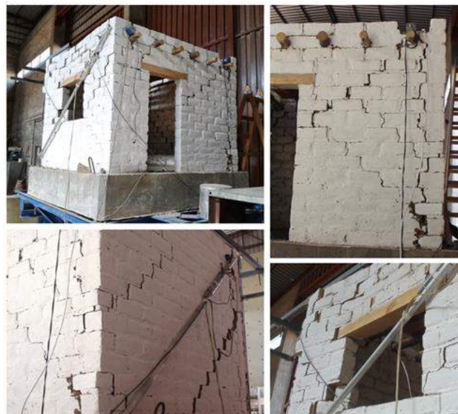
Figura 5. Daños observados al final del ensayo en el modelo sin reforzar.
