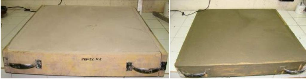
Figura 2 – Paneles de quincha rellenos con barro y revocados para conformar una superficie bien lisa para el ensayo.
