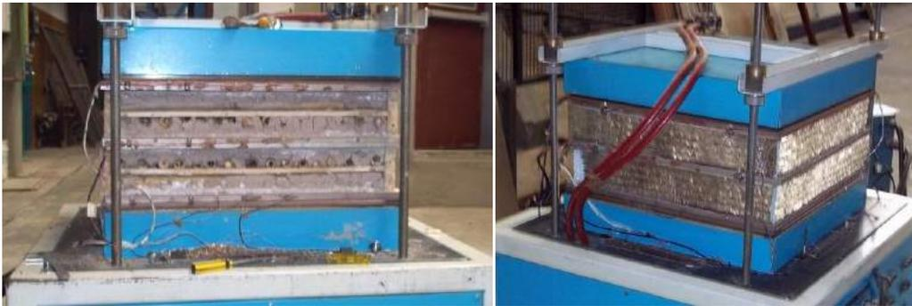
Figura 3 – Disposición de los paneles en las máquinas de placa caliente en el INTI para el ensayo de transmitancia térmica.
